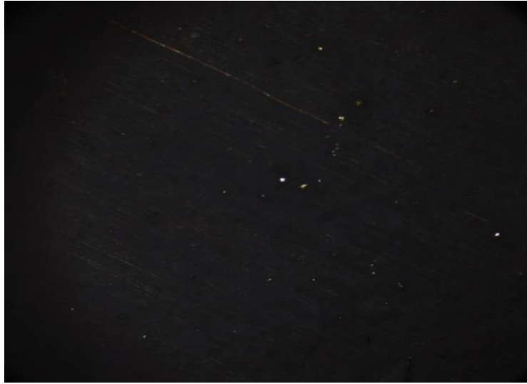
Рисунок 2.1 – Нефть залежи фундамента при 65 °С (нет признаков наличия кристаллов парафина)
