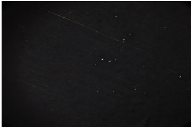
Рисунок 2.2 – Нефть залежи фундамента при 61 °С (нет признаков наличия кристаллов парафина)
