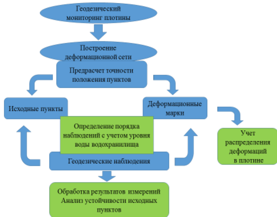
Рисунок 3.1 – Блок-схема геодзического мониторинга плотин (зеленым цветом выделены блоки, в которых присутствует новизна исследований, синим – традиционный порядок наблюдений)
