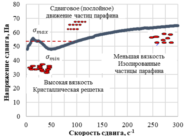
Рисунок 1 – Интерпретация немонотонности кривой течения высокопарафинистой нефти залежи D 2ef при температуре 30 °С
