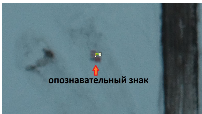
Рисунок 3.4 – Фотография, включающая изображение опознака, произведенная на высоте 120 м
