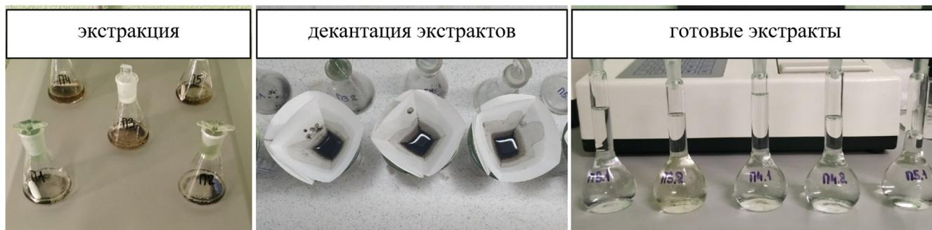
Рисунок 2.4 - Подготовка проб почв для анализа по определению массовой концентрации нефтепродуктов флуориметрическим методом
