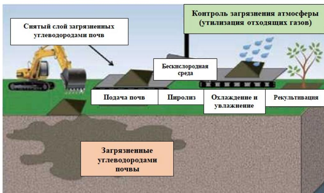
Рисунок 1.10 - Схематическое изображение применение пиролитической очистки загрязненных углеводородами почв [203]
