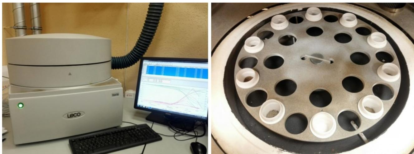
Рисунок 4.1 - Термогравиметрический анализатор LECO TGA701: слева - общий вид; справа - карусель загрузки проб
