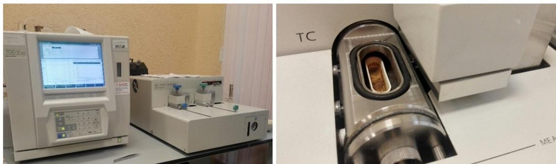
Рисунок 2.7 Анализатор TOC-V CSH: слева - общий вид анализатора; справа - загрузка пробы почв в анализатор
