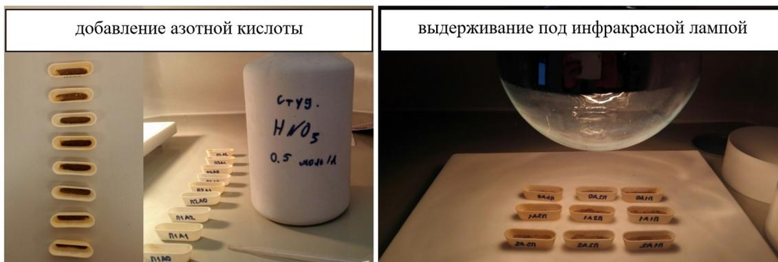
Рисунок 2.6 - Пробоподготовка почв для определения общего органического углерода
