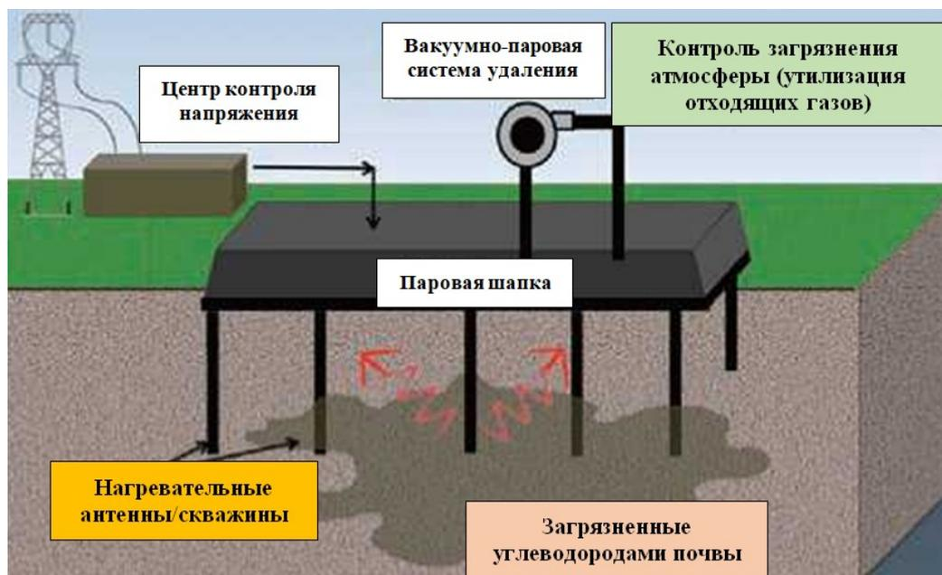
Рисунок 1.12 - Схематическое изображение применения метода радиочастотного нагрева для очистки загрязненных углеводородами почв [203]
