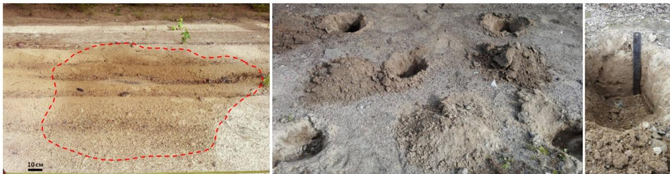
Рисунок 2.2 - Отбор проб и определение площади разлива свежего пятна загрязнения (на примере отбора проб с пробных площадок группы исследуемых резервуарных парков)
