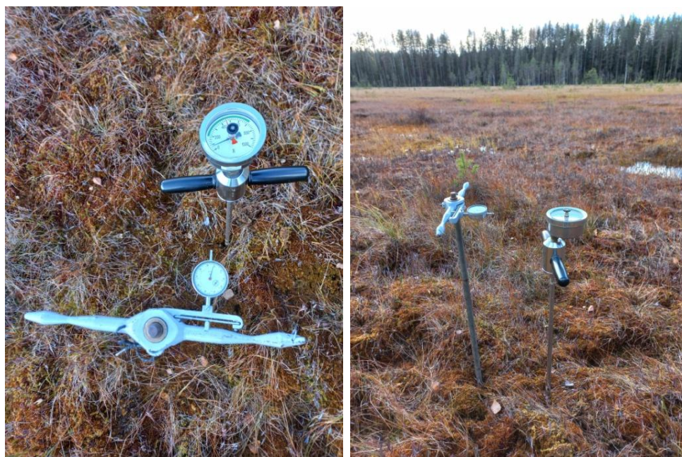
Рисунок 27 – Сдвигомер-крыльчатка СК-10 и пенетрометр Eijkelkamp 0601SA Значение удельного сопротивления грунта (45)
