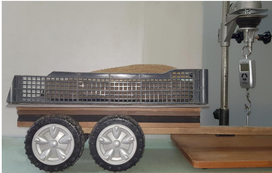
Рисунок 57 - Определение рациональной длины дышла на модели полуприцепа
