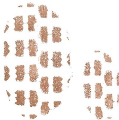
Рисунок 41 – Относительное изменение площади пятна контакта шины с изменением нагрузки от 0,2 до 0,6 кН и давления накачивания от 0,1 до 0,2
