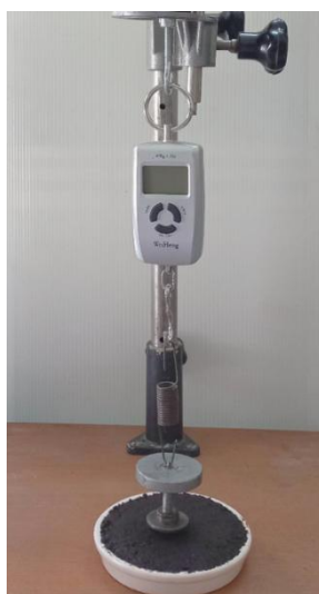
Рисунок 35 – Прибор для определения адгезии торфяного сырья по способу постепенного нормального отрыва
