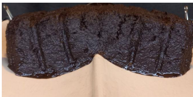
Рисунок 53 – Определение угла соскальзывания торфяного бруска на модели поверхности с двойным полуэллиптическим поперечным сечением (double half-pipe)
