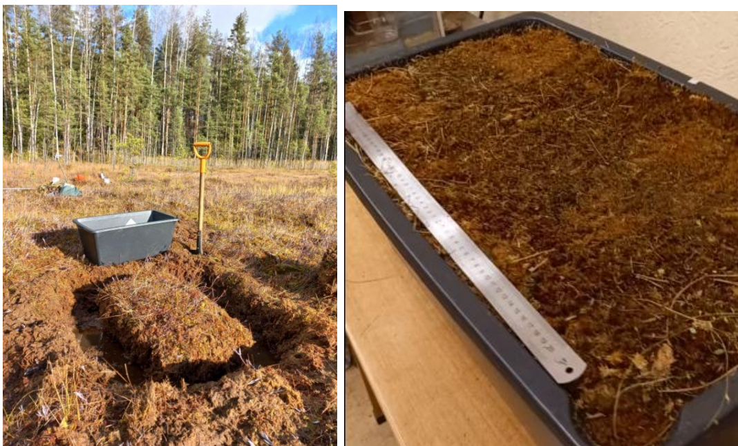
Рисунок 23 – Подготовка монолита торфяной залежи
