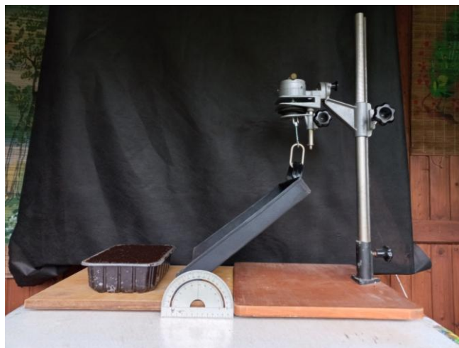
Рисунок 30 – Лабораторный стенд для определения угла соскальзывания торфяного сырья с поверхности кузова
