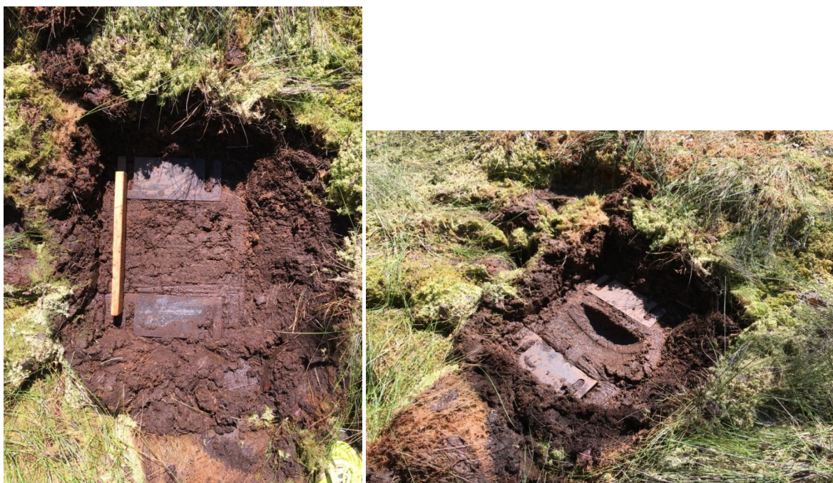
Рисунок 28 – Определение осадки методом штамповых испытаний модельным колесом с шиной R330/88
