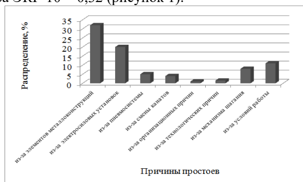
Рисунок 1 – Распределение относительного потока отказов экскаватора ЭКГ-10 по узлам и причинам простоев
