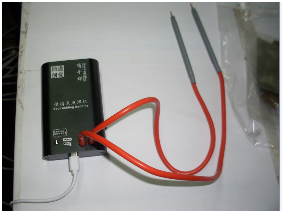
Рисунок 2.8 – Сварочный аппарат для контактной сварки
