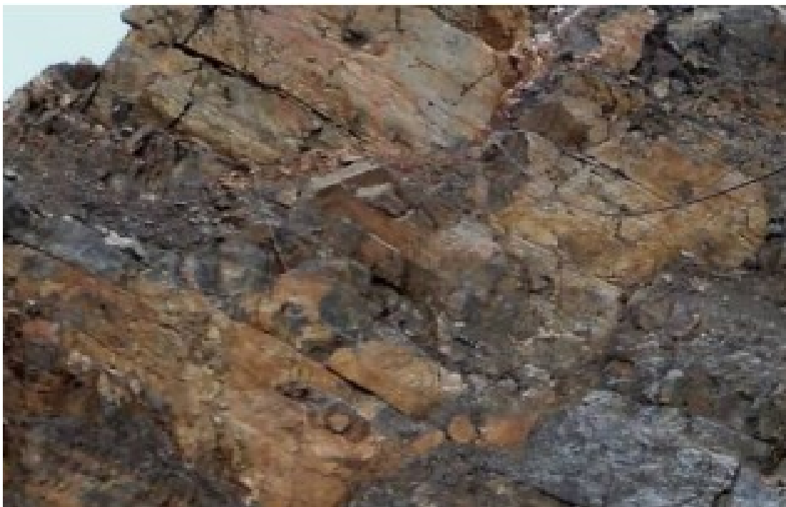
Рисунок 3.4 – Общий вид блочности массива невзорванных пород
