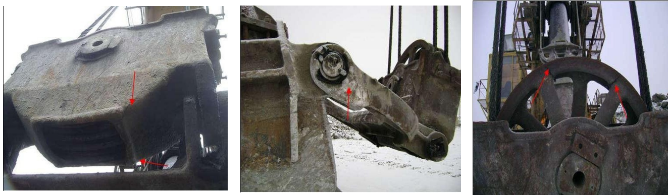
Рисунок 1.4 – Трещины в подвеске ковша экскаватора ЭКГ-10
