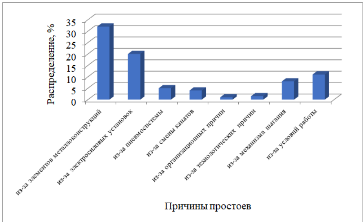
Рисунок 3.1 – Распределение относительного потока отказов экскаватора ЭКГ-10 по узлам и причинам простоев
