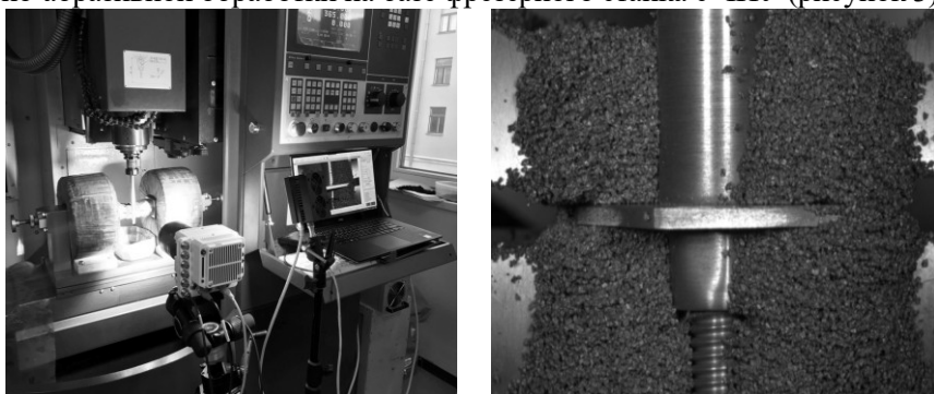
Рисунок 3 – Магнитно-абразивная обработка: а) – установка на станке с ЧПУ; б) – процесс обработки изделия
