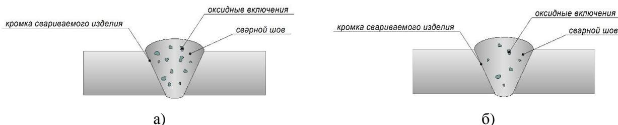
Рисунок 1.10 – Оксидные включения в сварном соединении: а – при шероховатости поверхности  $Ra = 2,5$  мкм; б – при шероховатости поверхности  $Ra = 0,5$  мкм
