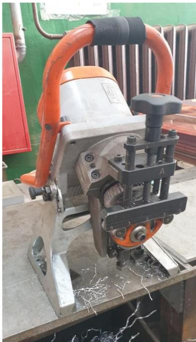
Рисунок 1.7 – Станок для разделки кромок
