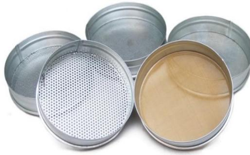
Рисунок 2.9 – Ручные металлические сита
