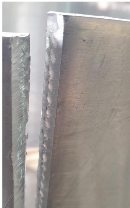
Рисунок 1.8 – Состояние кромки алюминиевого листа после разделки
