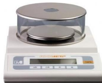
Рисунок 3.6 – Измерительные весы марки ВЛТЭ 310
