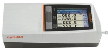
Рисунок 3.5 - Профилометр *Mitutoyo Surftest SJ-210*
