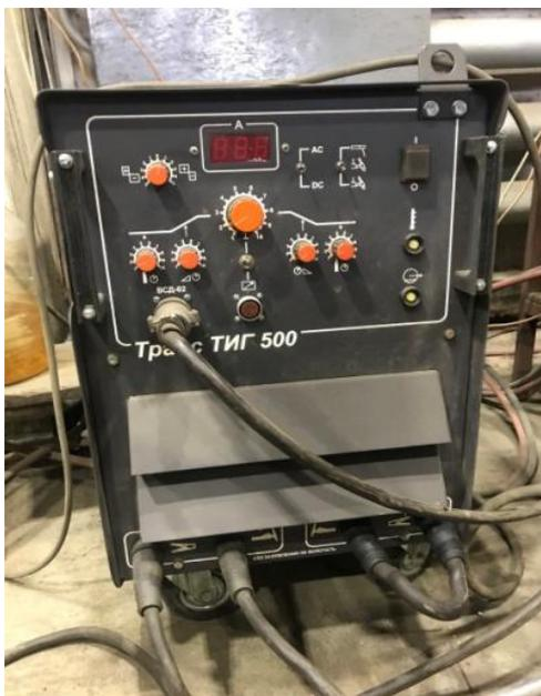
Рисунок 4.1 – Сварочный аппарат Транс ТИГ 500
