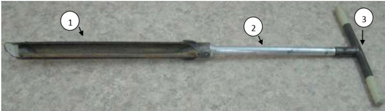
Рисунок 3.1 – Бур пробоотборочный ТБГ-1: 1 – пробоотборник (челнок); 2 – штанга; 3 – ручка
