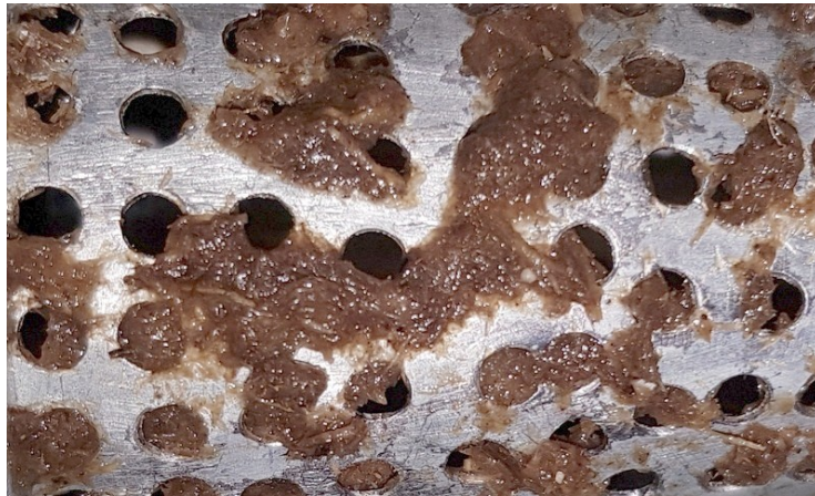
Рисунок 4.15 – Волокна торфяного сырья на сетке
