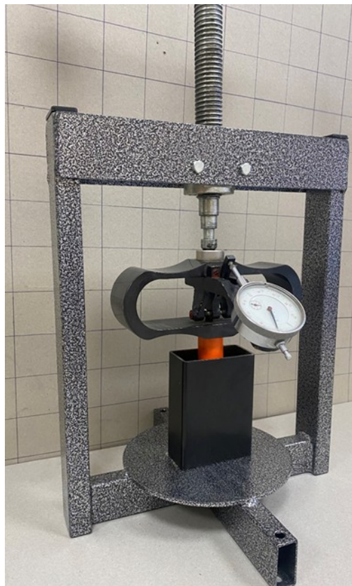
Рисунок 3.7 – Общий вид лабораторной установки с винтовым прессом
