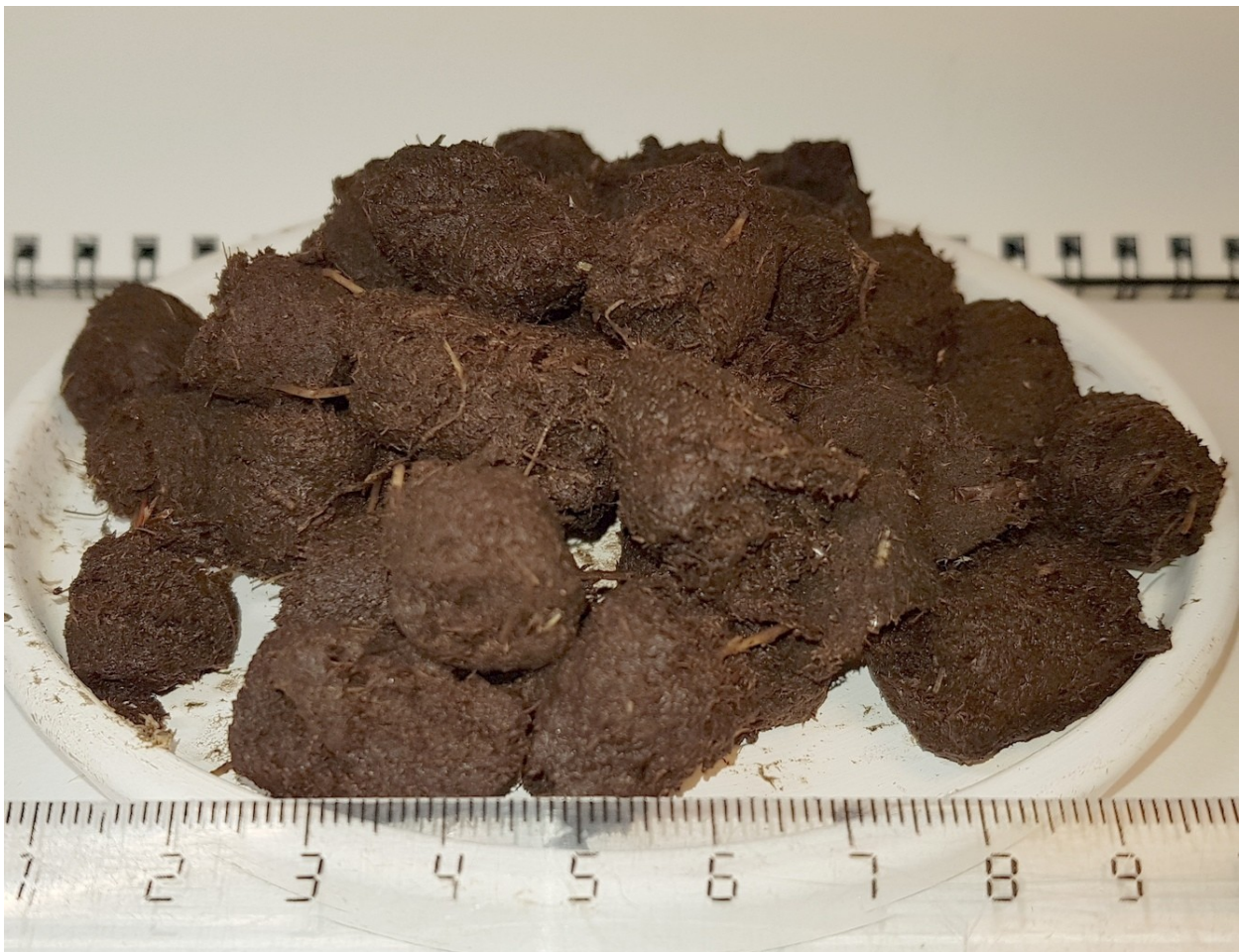
Рисунок 4.20 – Смесь торфяного сырья после обезвоживания
