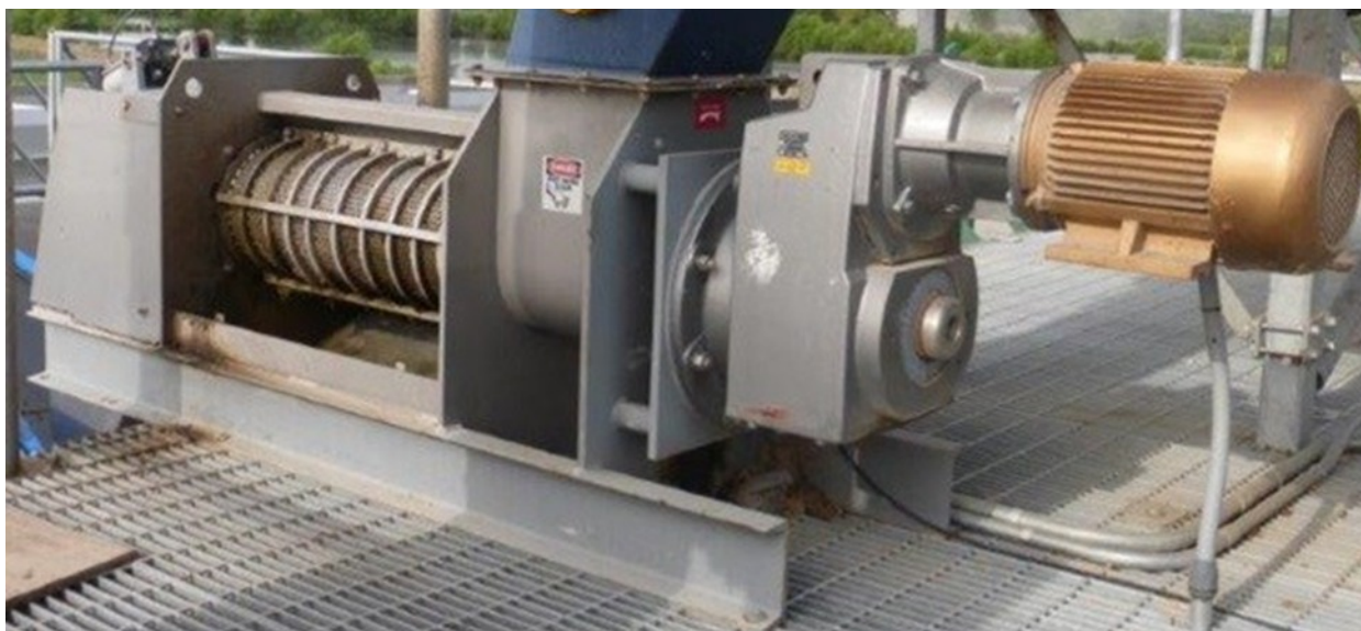
Рисунок 1.12 – Шнековый пресс модели КР компании Vincent Corporation
