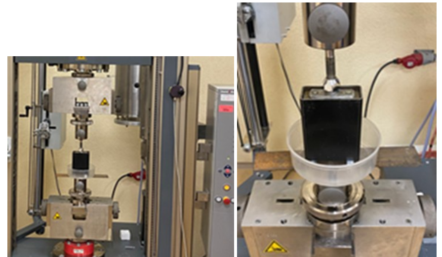
Рисунок 5 – Общий вид лабораторной установки и рабочая камера с лотком для сбора воды
