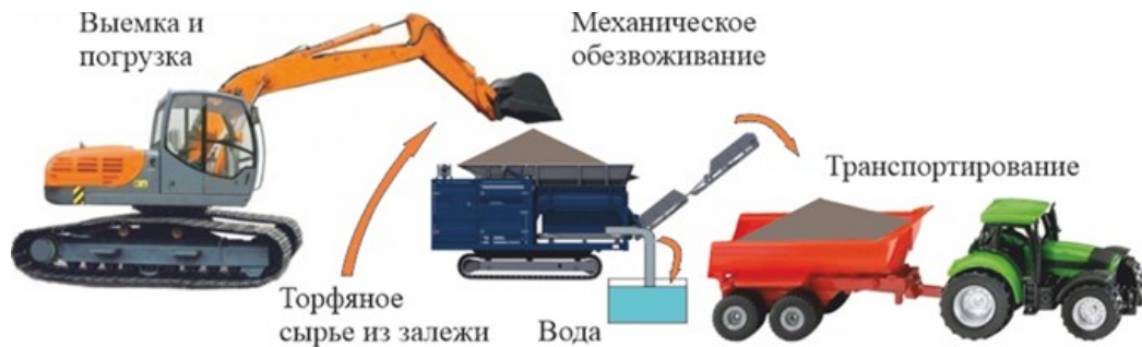
Рисунок 1 - Система внутрикарьерного механического обезвоживания и транспортирования при добыче торфяного сырья
