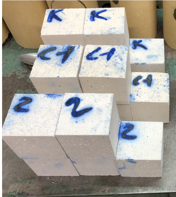
Рисунок 25 - Образцы огнеупорной бетонной смеси
