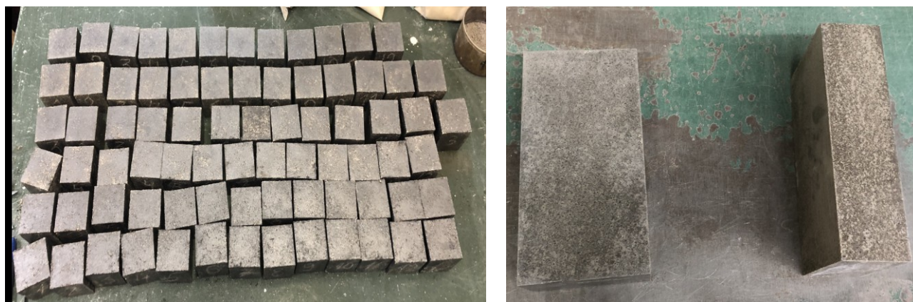
Рисунок 18 - Образцы огнеупорных материалов с добавкой технического микрокремнезема.
