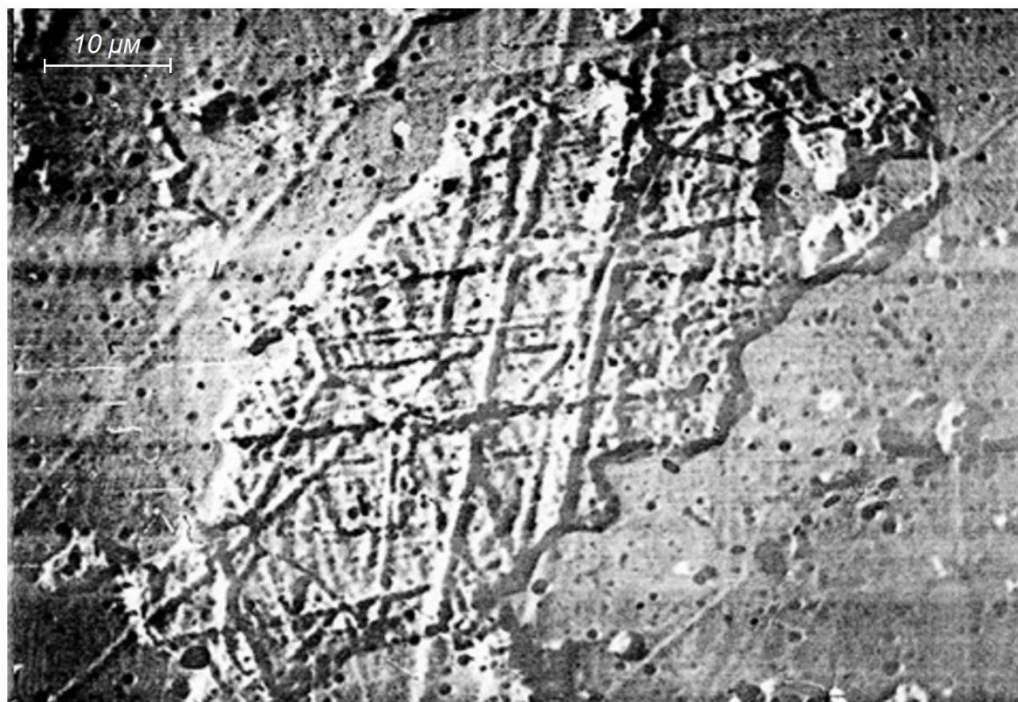
Рисунок 2.7 - Поры режущей керамики при увеличении в 50000 раз
