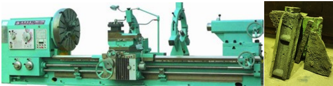
Рисунок 4.1 – Токарный станок ДИП-600 и заготовки, полученные при утилизации данного станка
