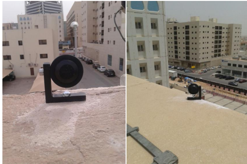
Рисунок 4.9 – Вид на мини-призмы, установленные на верхних этажах зданий
