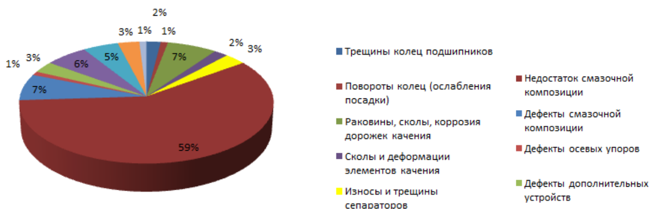
Рисунок 1.39 – Диаграмма причин отказов подшипниковых узлов экскаваторов типа ЭКГ-18Р/20К
