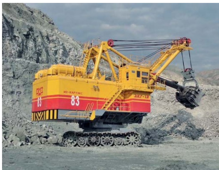
Рисунок 1.29 – Карьерный экскаватор ЭКГ-10 на Коршуновском железорудном карьере
