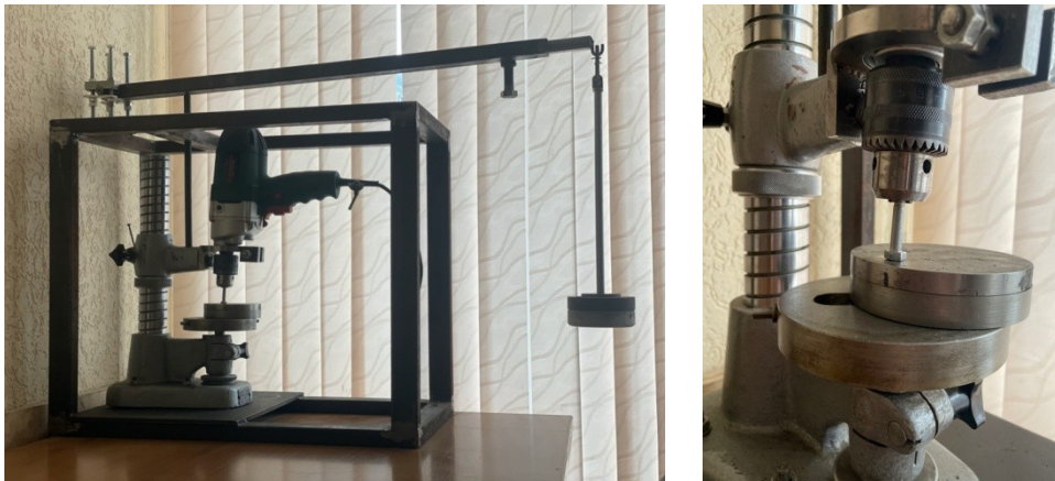
Рисунок 3.3 – Стенд для оценки трения в контакте ресурсопределяющих элементов трансмиссии «индентор-контртело»
