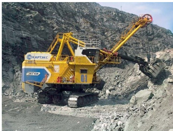
Рисунок 1.31 – Карьерный экскаватор ЭКГ-12К на Оленегорском железорудном карьере
