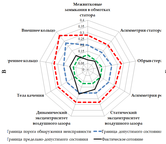
Рисунок 4.34 – Диаграмма технического состояния: а – n_d=0 ; б – n_d=1 ; в – n_d=2 ; г – n_d=3
