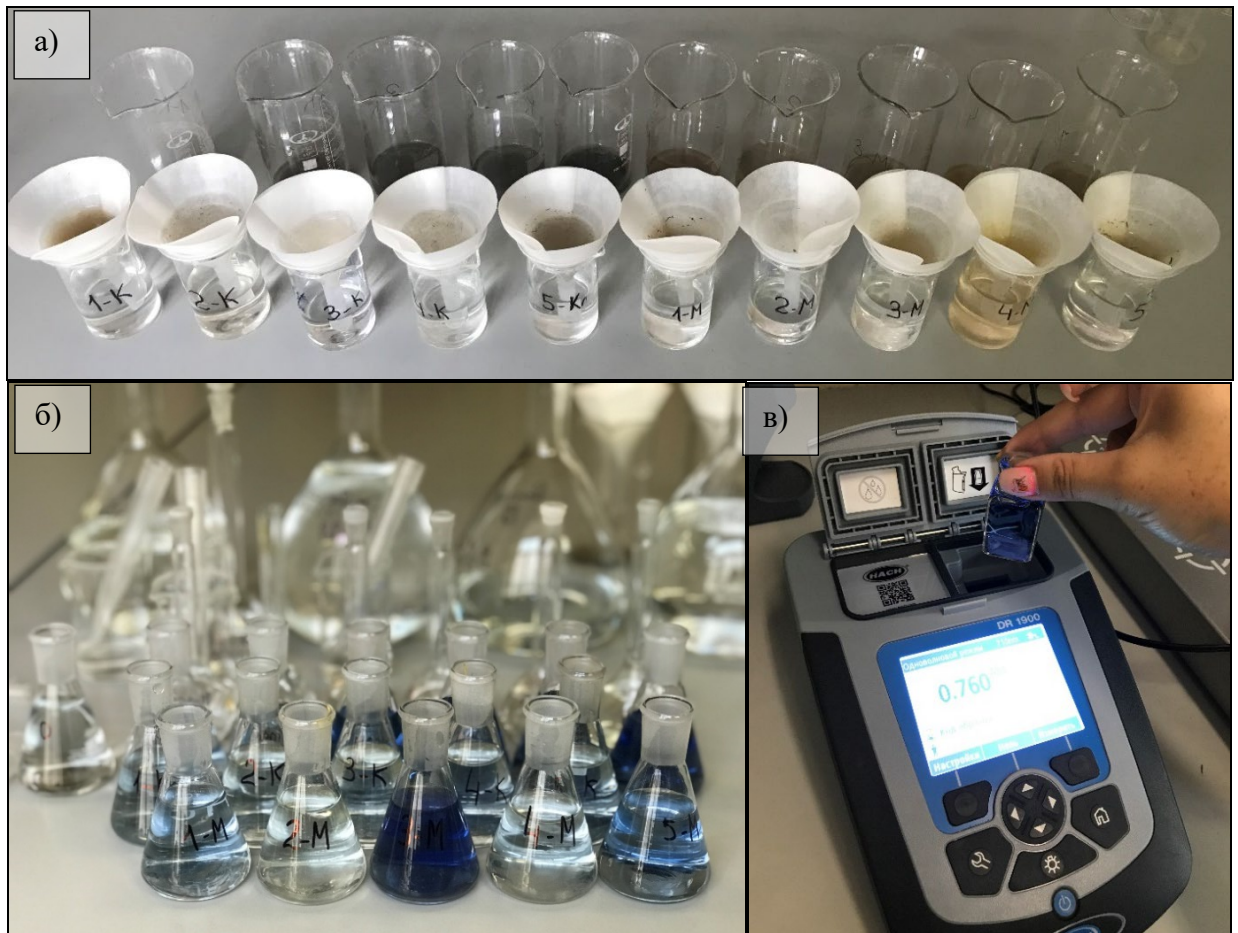
Рисунок 3.33 – Определение подвижного фосфора фотометрическим методом на DR 1900: 1 – фильтрование подготовленных вытяжек проб по ГОСТ 26204-91, 2 – Приготовленные анализируемые растворы проб, 3 – Фотометр DR 1900
