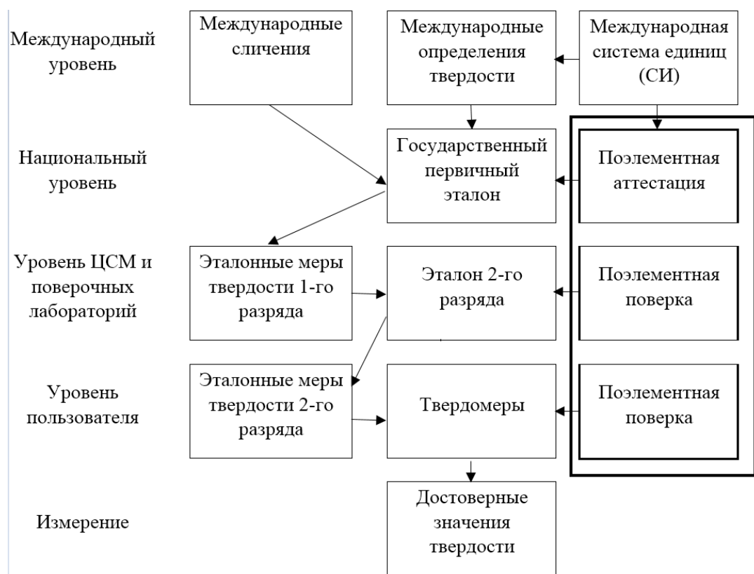
Рисунок 17 – Обобщенная структура обеспечения прослеживаемости (метрологической цепи) для определения и распространения шкал твердости Либа [47]
