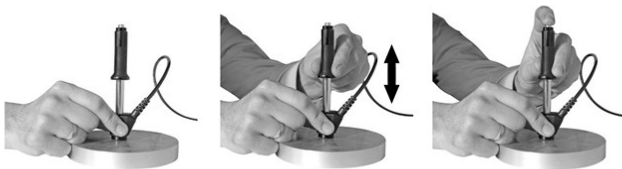
Рисунок 5 – Проведение измерений ударным преобразователем типа D
