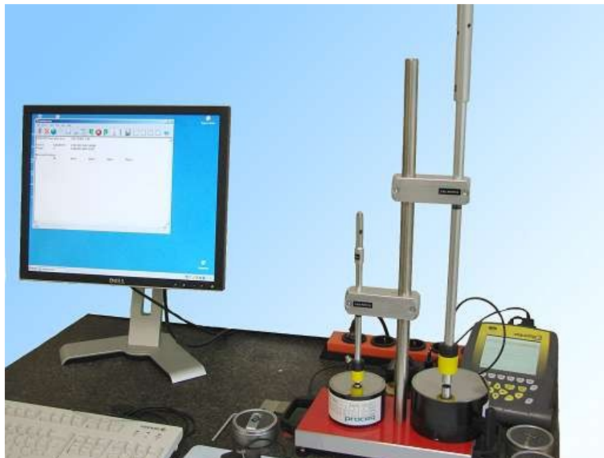
Рисунок 22 – Первичный эталон шкал твердости Либа в Physikalisch-Technische Bundesanstalt (PTB), Германия
