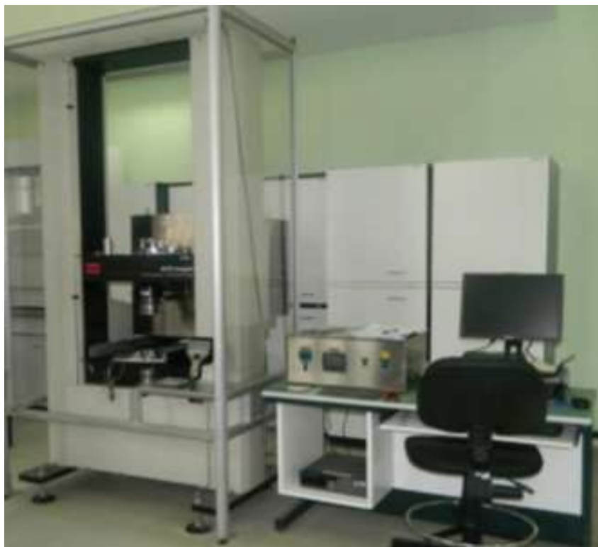
Рисунок 2.5– Общий вид установки MTS Insight
