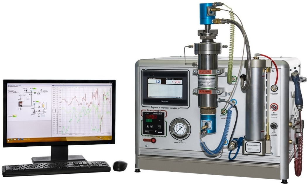
Рисунок 2.4—Анализатор газопроницаемости и пористости ПИК-ПП
