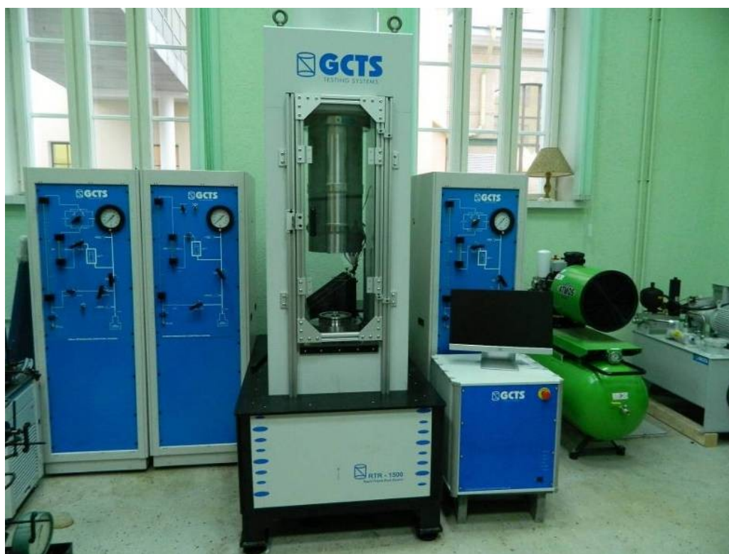
Рисунок 2.11– Общий вид сервогидравлической установки RTR 1500
