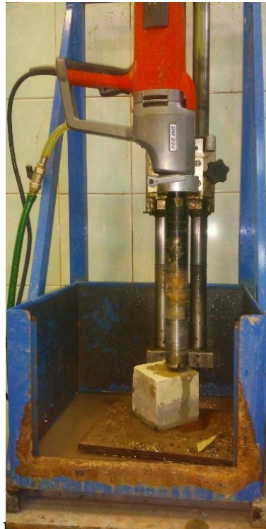
Рисунок 2.1 Буровой станок Husqvarna DM 320
