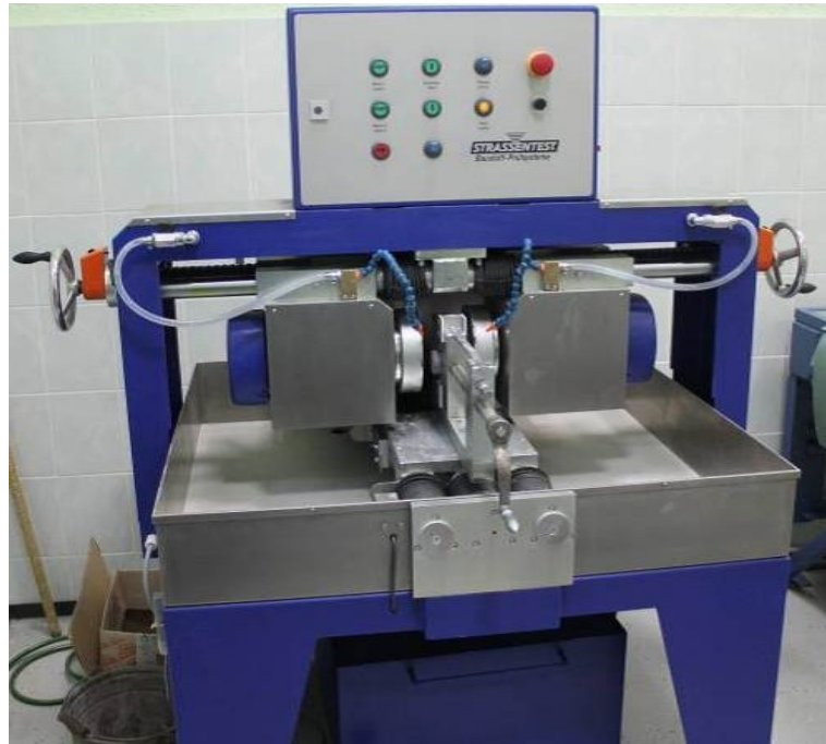
Рисунок 2.2– Шлифовальный станок Strassentest
