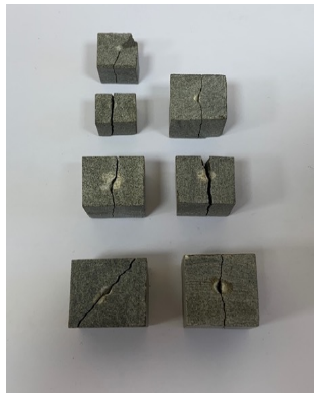
Рисунок 4.4 – Вид образцов песчаника, расколотых в результате ударного воздействия модельного инструмента
