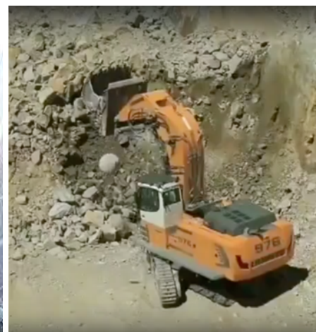
Рисунок 1.7 – Сбрасывание шар-бабы с ковша экскаватора
