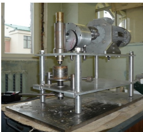
Рисунок 2.8 – Вид установки по разрушению горной породы и пластической деформации металлов
