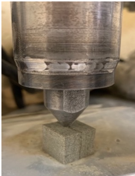
Рисунок 4.4 – Вид образцов песчаника, расколотых в результате ударного воздействия модельного инструмента
