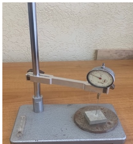
Рисунок 2.13 – Вид индикатора часового типа ИЧ 0-10 0.01, используемого для измерения глубины лунок в пластинах породы и металлов
