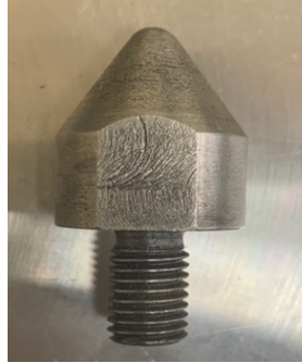
Рисунок 2.11 – Вид индентора модельного инструмента
