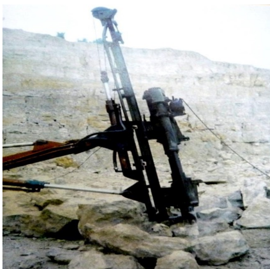
Рисунок 1.5 – Дизель-молот штанговый ДМ-150 при дроблении известняка
