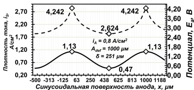
Рисунок 2 - Распределение тока (сплошная линия) и потенциала (пунктирная линия) по поверхности малорасходуемого анода при  $\delta = 251 \mu\text{м}$
