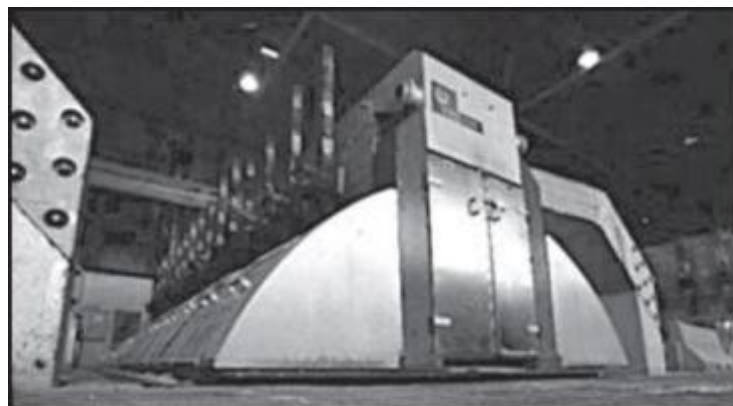
Рисунок 1.9 - Электролизер Halsee с потреблением энергии 12,1 кВт·ч/кг Al [97]
