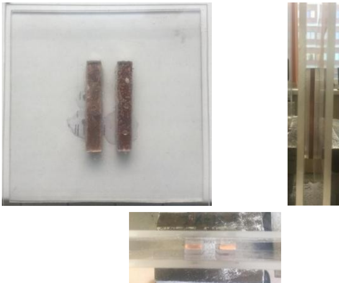
Рисунок 3.2 – Конструкция ячейки водной модели с использованием медных электродов
