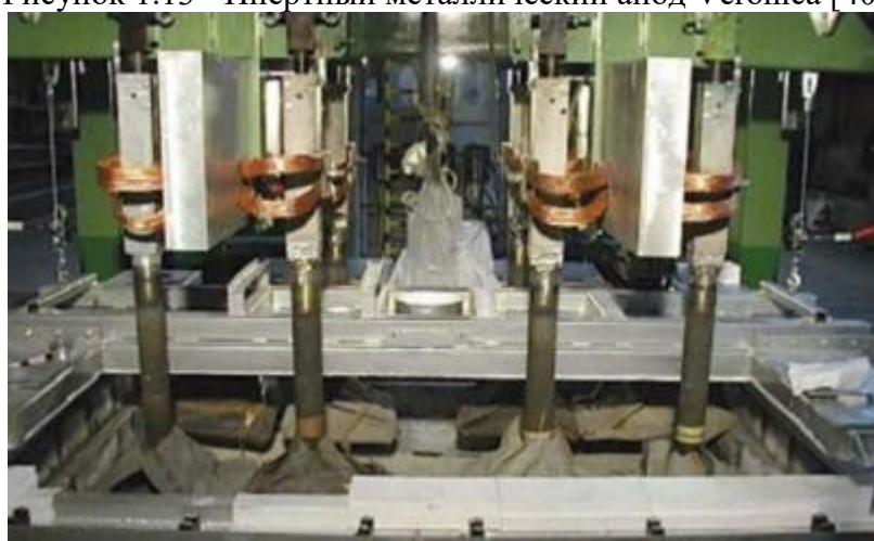
Рисунок 1.13 - Инертный металлический анод Veronica [40]
