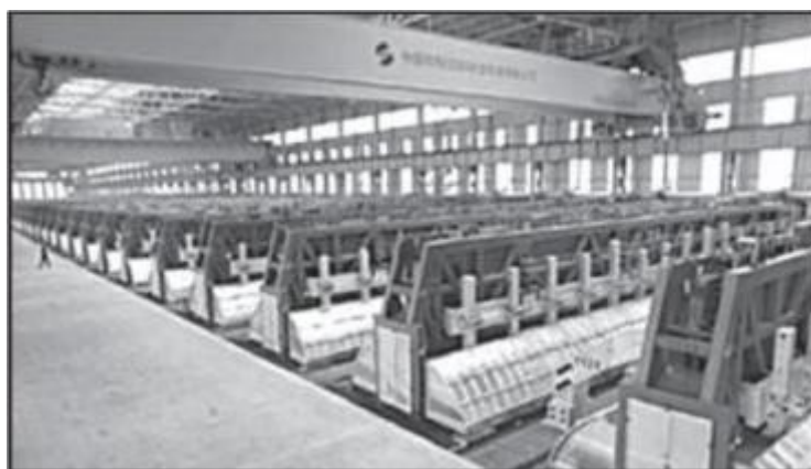
Рисунок 1.5 - Электролизеры NEUI 600 кА на алюминиевом заводе Shandong Weiqiao [102]
