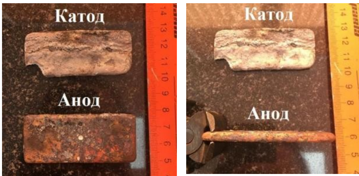
Рисунок 3.34 – состояние эллиптических электродов Cu-Ni-Fe после электролиза
