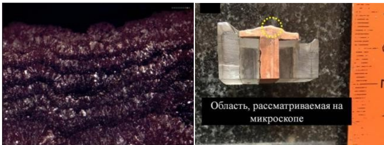
Рисунок 3.16 - Снимки шлифа продольного разреза катода, полученные оптической микроскопией (увеличение 20х): а) верхушка «шапки»; б) общий вид шлифа с областью, анализируемой на микроскопе
