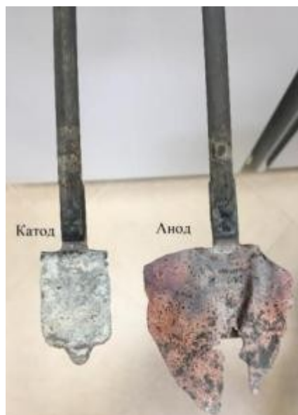
Рисунок 3.18 – Состояние электродов после эксперимента ЭПМ1
