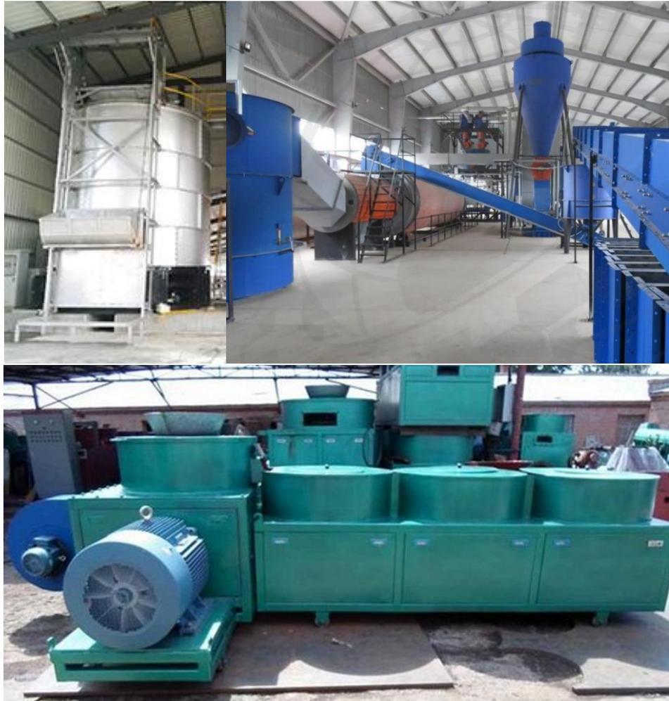
Рисунок В.2 – Примеры оборудования для подготовки нетрадиционных мелиорантов для использования (бункер для сбора и сушки, комплекс для прессования с сушкой),
