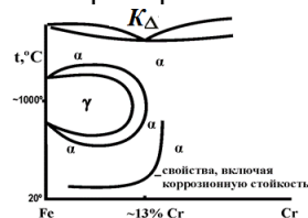
Рисунок 2 – Схематизированная часть диаграммы Fe – Cr и зависимость свойств от состава
