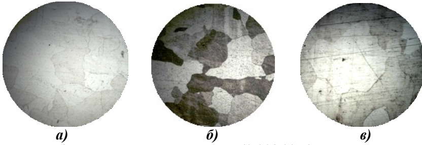
Рисунок 9 – Микроструктура железа (0,008 % С) после нагрева на 850 °С и изотермической выдержки при 620 (а), 640 (б) и 660 °С (в), x200
