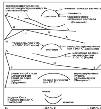
Рисунок 1 – Схематизированная часть диаграммы Fe – C и зависимость свойств от % C
