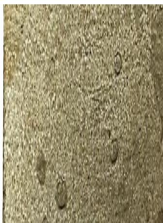
Блистеры – после испытаний, на поверхности образца слой отложений и вспучивания
