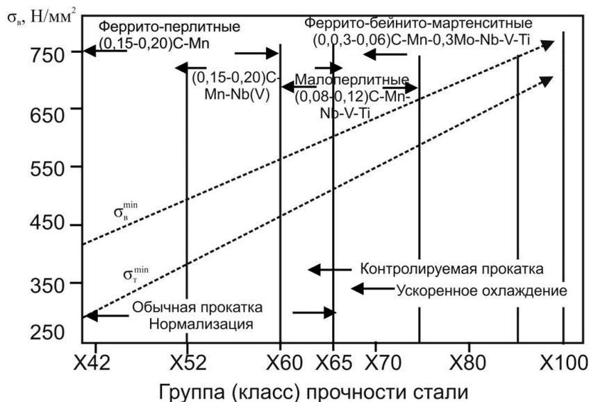
Рисунок 1.2 – Схема эволюции трубных сталей и способов их производства [31]
