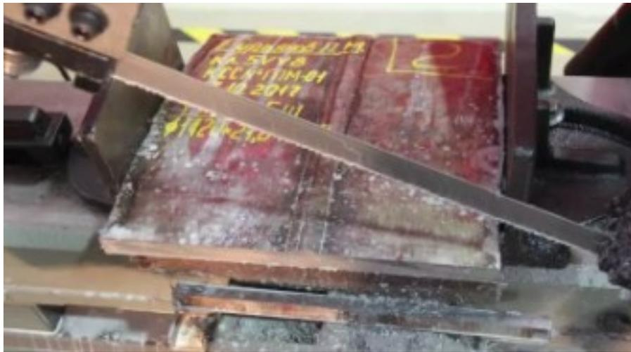
Рисунок 2.2 – Разделка темплетов с использованием ленточнопильного станка для вырезки заготовок под образцы
