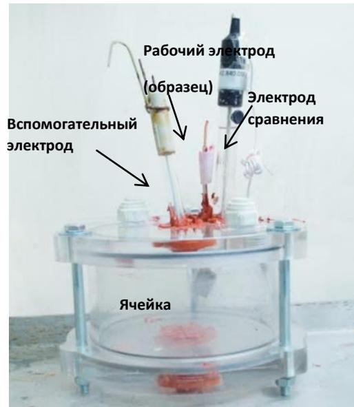
Рисунок 2.3 – Внешний вид электрохимической ячейки
