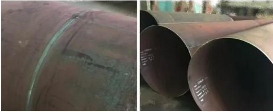
Рисунок 2.1 – Внешний вид исследованных труб из стали 10Г2ФБ в состоянии поставки
