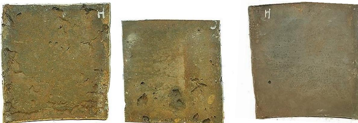
Рисунок 5.2 – Вырезки металла труб после эксплуатации – слева направо – 09Г2С, 13ХФА, X56
