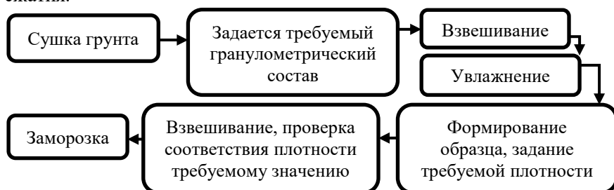
Рисунок 4 – Структурная схема методики создания стандартного образца.
