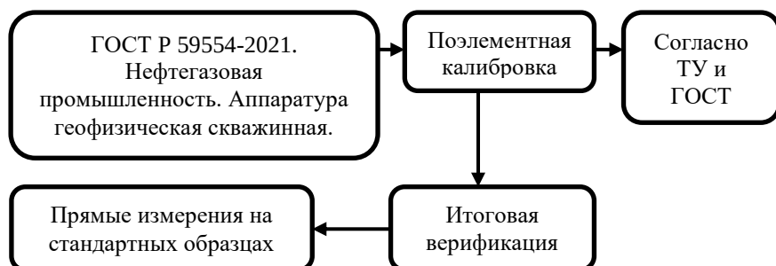
Рисунок 5 – Проект метрологического обеспечения системы геотехнического мониторинга оснований сооружений на вечномерзлых грунтах.
