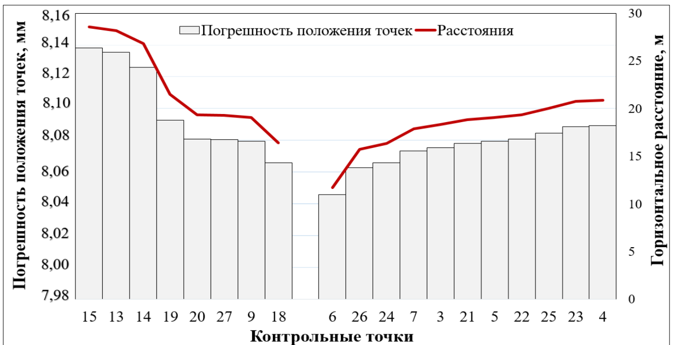
Рисунок 2.20 – Связь между общей погрешностью и горизонтальными расстояниями для ТЛО при НЛС со станции №1
