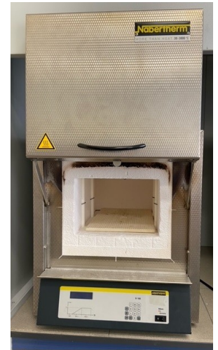
Рисунок 2.7 – Муфельная печь Nabertherm
