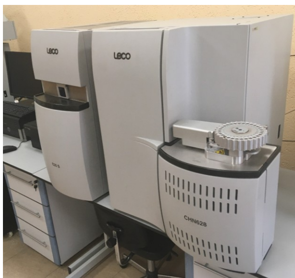
Рисунок 2.13 – Анализатор общего углерода в твердых образцах CHNS628 фирмы LECO
