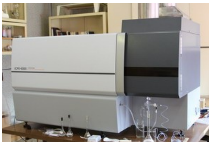
Рисунок 2.12 – Атомно-эмиссионный спектрометр с индуктивно-связанной плазмой ICPE-9000
