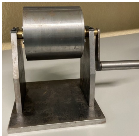
Рисунок 2.8 – Механический барабан с истирающим стержнем
