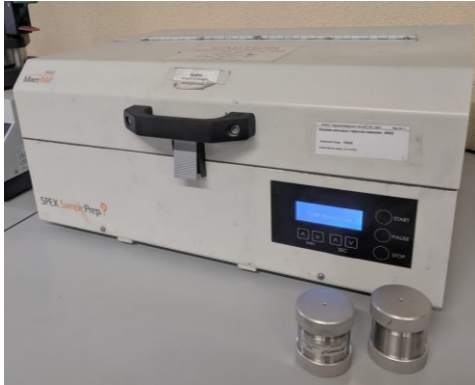
Рисунок 2.5 – Шаровая мельница Spex Dual Mixer/Mill
