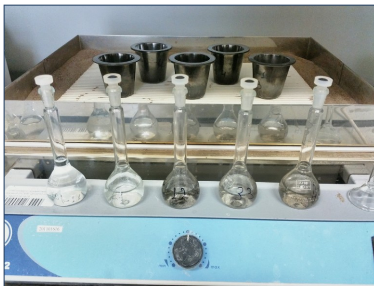
Рисунок 3.23 – Разложение отработанного нефтесорбента до мокрых солей
