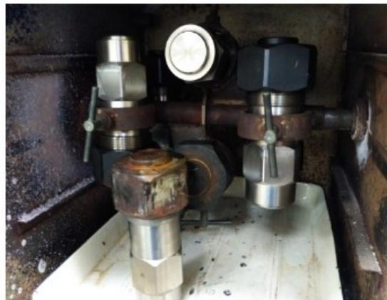
Рисунок 2.23 – Установка для автоклавного выщелачивания
