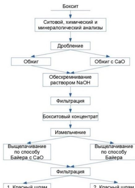
Рисунок 2.11 – Технологическая схема термохимического обогащения алюминий содержащего сырья по технологии «Термохимия-Байер»
