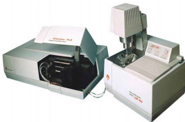
Рисунок 2.17 - Лазерный анализатор частиц «Микросайзер 201С»
