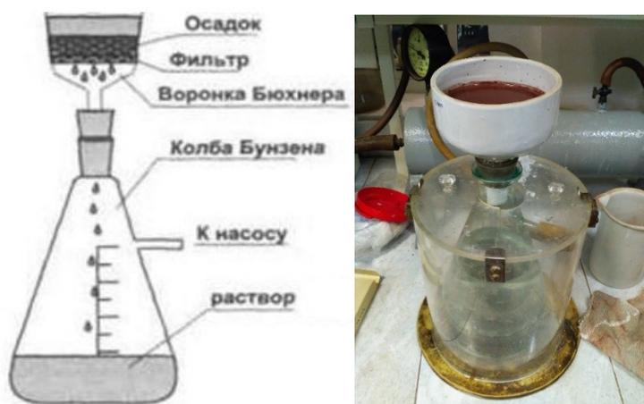
Рисунок 2.28 – Внешний вид установки для разделения пульпы под разряжением
