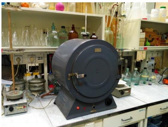
Рисунок 2.30 – Лабораторный сушильный шкаф
