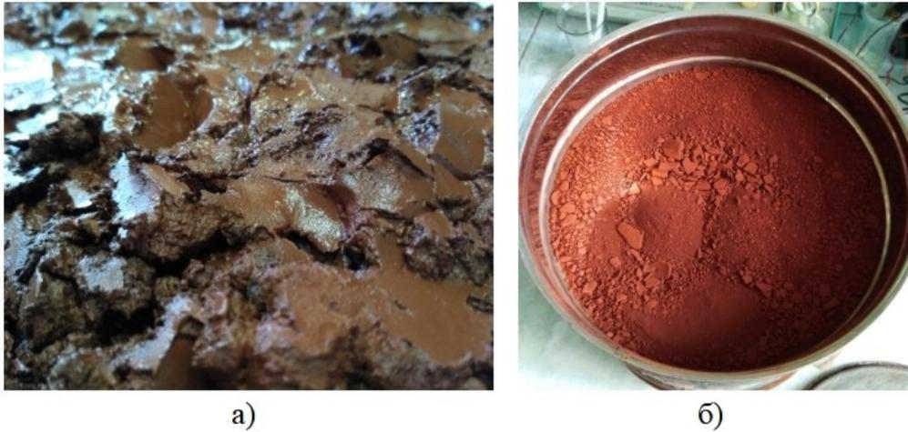
Рисунок 3.32 – Красный шлам: а) до сушки; б) после сушки
