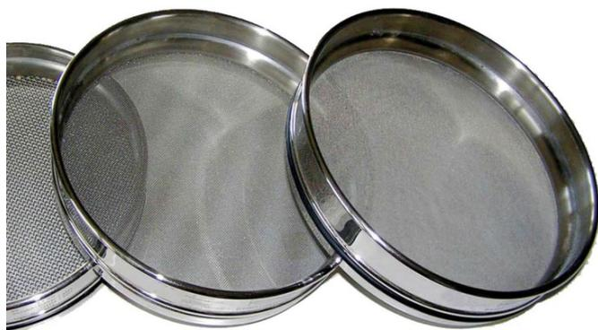
Рисунок 2.15 – Лабораторные сита
