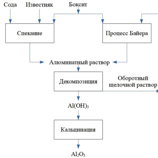
Рисунок 1.5 – Упрощенная технологическая схема осуществления параллельного варианта Байер-спекание [67]
