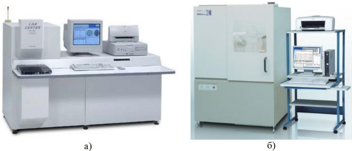
Рисунок 2.13 – Оборудование для определения химического и фазового составов: а) XRF-1800; б) XRD-7000
