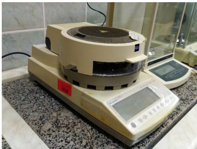
Рисунок 2.31 – Электронный анализатор влажности МОС-120Н
