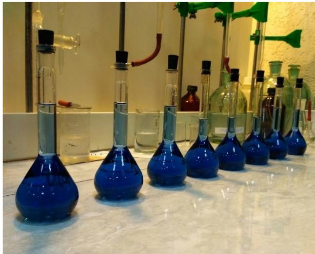
Рисунок 2.33 – Подготовка растворов для определения  $\text{SiO}_2$  при помощи спектрофотометра
