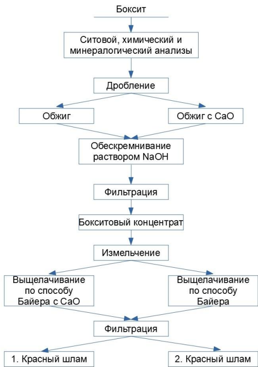
Рисунок 1 – Технологическая схема термохимического обогащения алюминий содержащего сырья по технологии «Термохимия-Байер»
