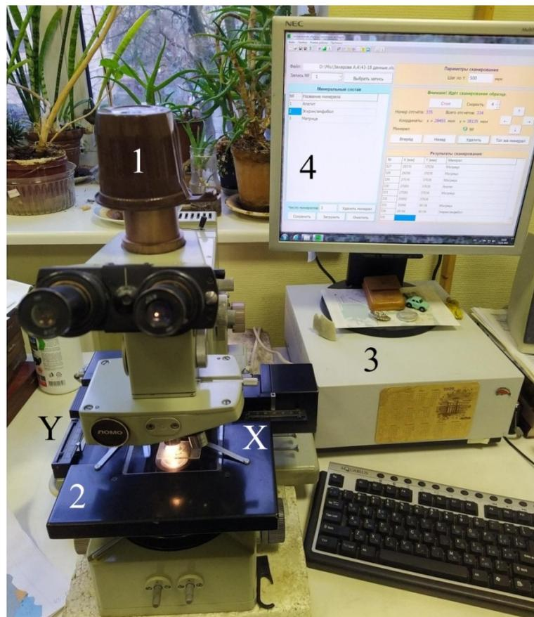
Рисунок 52 – Общий вид анализатора МИУ-5М. Буквами показано расположение координатных осей. Цифрами обозначены: 1 – микроскоп, 2 – сканирующий столик, 3 – электродвигатель, 4 – монитор рабочего компьютера. Блоки питания расположены справа под рабочим столом.
