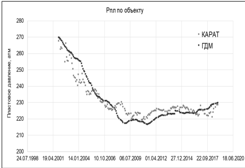
Рисунок 4 – Сравнение пластового давления, рассчитанного с помощью симулятора tNavigator и инструмента KARAT
