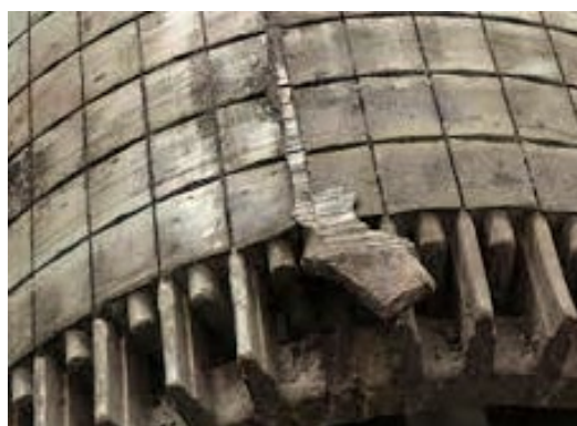
Рисунок 1.5.4 – Обрывы стержней ротора АД
