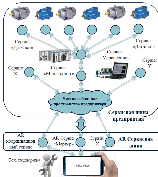
Рисунок 5.9.1 – Структурная схема реализации сервиса дополненной реальности
