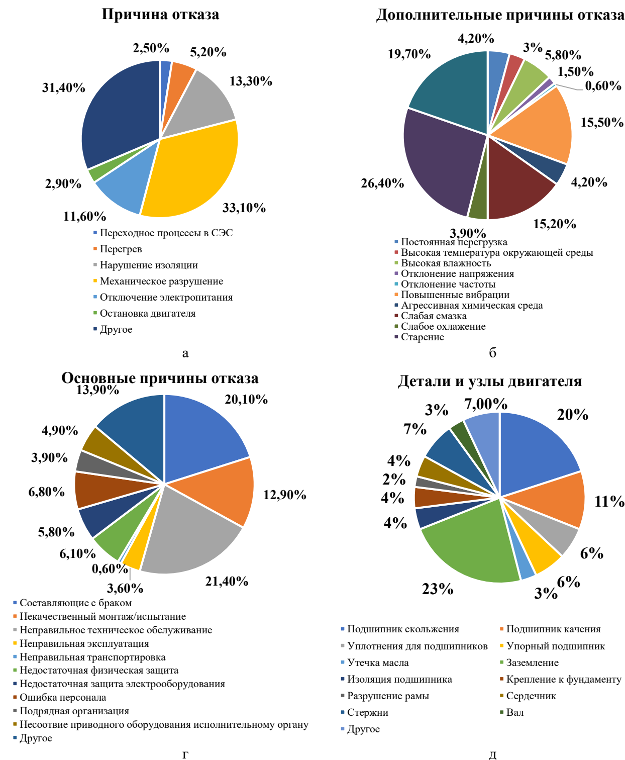
Рисунок 1.5.7 – Перечень отказов и их классификация: а – причина отказа; б – дополнительные причины отказа; в – основные причины отказа; г – детали двигателя
