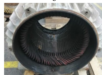
Рисунок 1.5.3 – Повреждения статора АД
