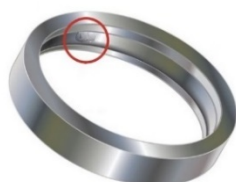
Рисунок 1.5.5 – Дефекты подшипников АД: а – сепаратора; б – внутреннего кольца; в – внешнего кольца; г – тела качения
