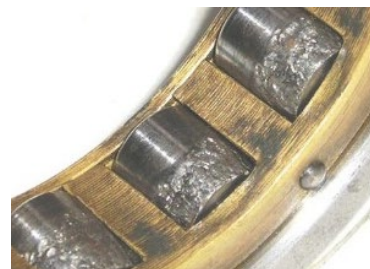
Рисунок 1.5.5 – Дефекты подшипников АД: а – сепаратора; б – внутреннего кольца; в – внешнего кольца; г – тела качения
