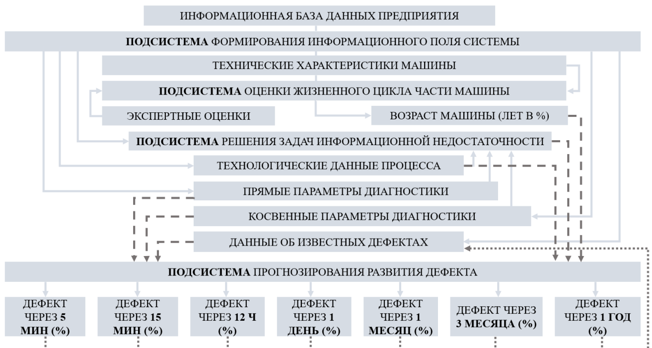
Рисунок 5.4.2 – Структурная схема прогнозирования развития дефектов
