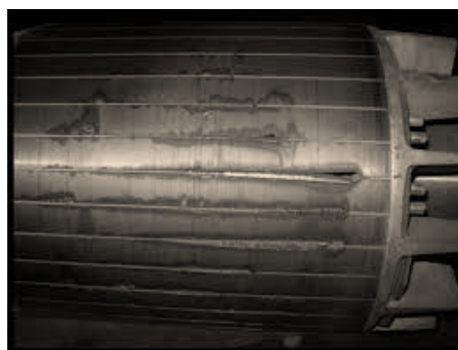
Рисунок 1.5.4 – Обрывы стержней ротора АД
