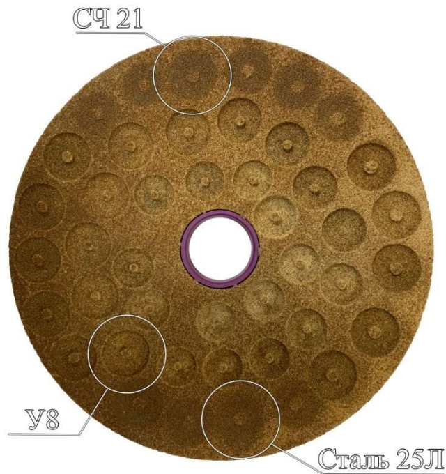
Рисунок 3.7 – Вид круга абразива после испытаний образцов материалов на изнашивание
