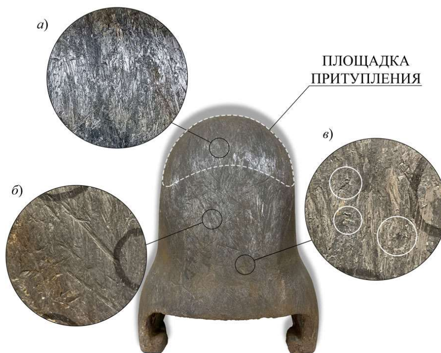
Рисунок 2.2 – Характерные виды следов воздействия породы на нижней поверхности коронки после работы по граниту
