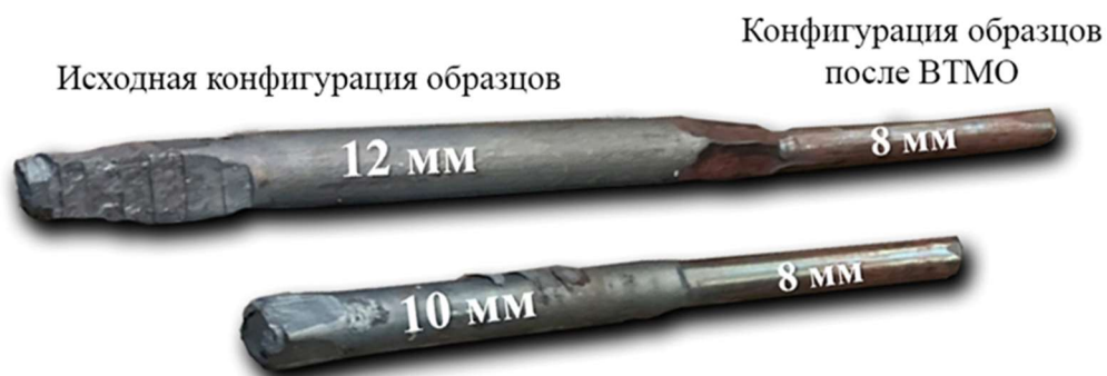
Рисунок 3.6 – Вид частей прутков стали неподверженных (слева) и подверженных (справа) ВТМО
