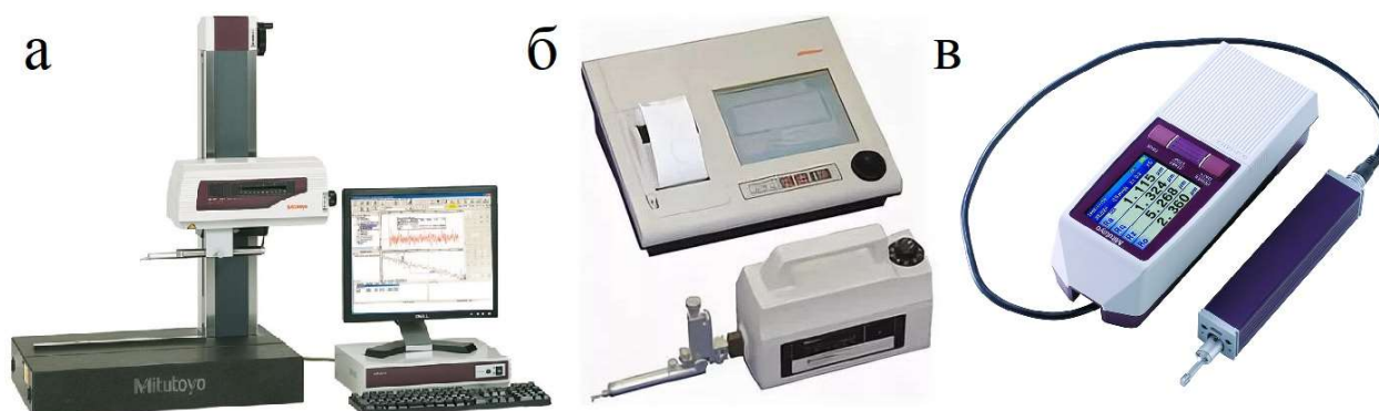
Рисунок 2.4 – Типы профилометров: а – стационарный профилометр Mitutoyo SurfTest SV-2100; б– стационарно-переносной профилометр Mitutoyo SurfTest SJ-410; в – портативный профилометр Mitutoyo SurfTest SJ-210
