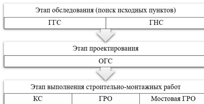
Рисунок 1.2 – Общая последовательность создания КС и ГРО
