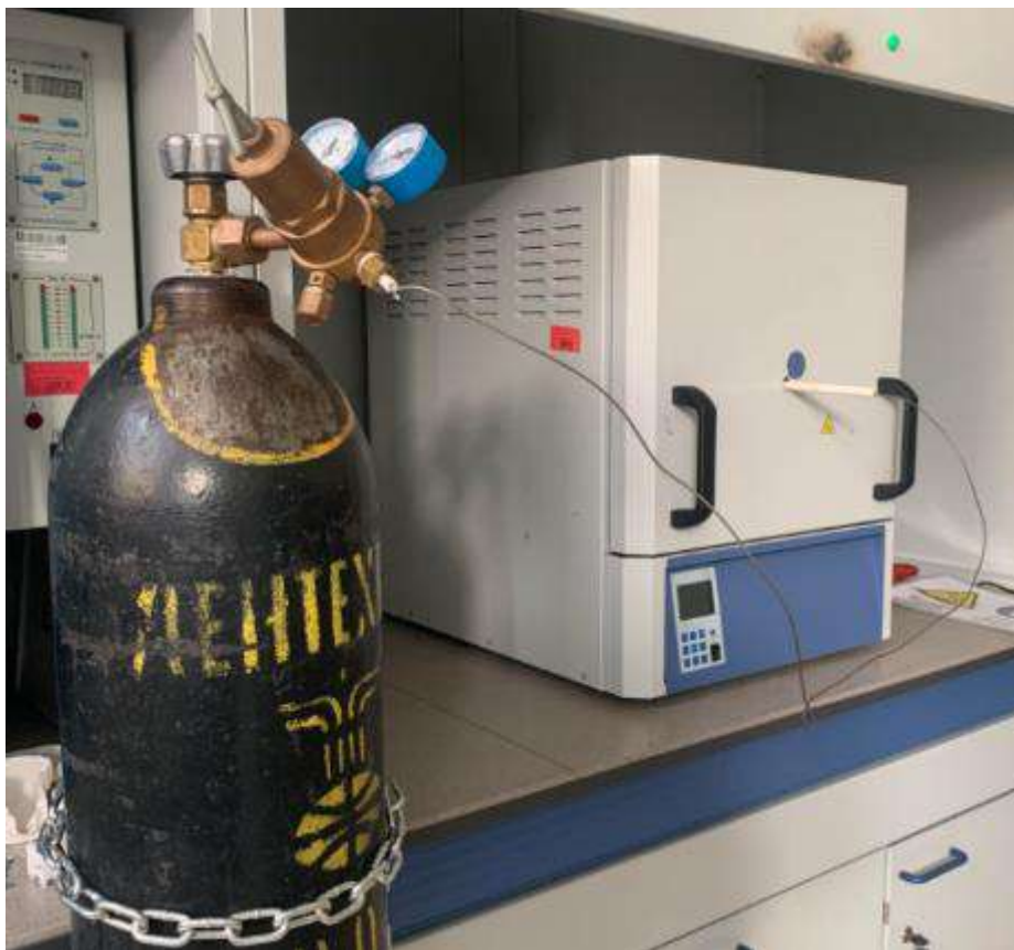
Рисунок 2.3 – Прокалка лабораторных образцов игольчатого кокса
