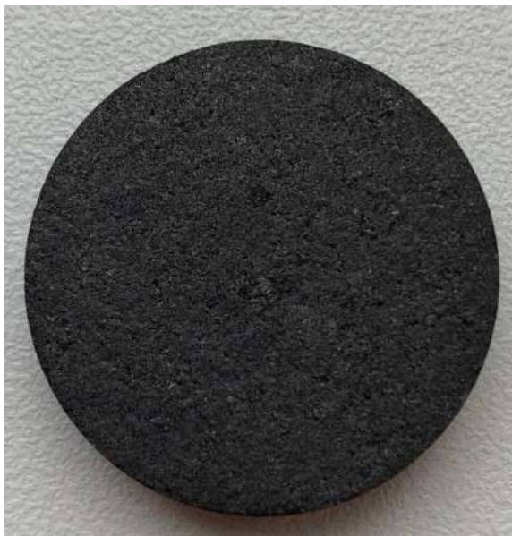
Рисунок 4.6 – Пример сформованного углекоксого композита
