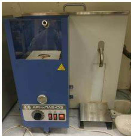
Рисунок 2.10 – Аппарат для разгонки нефтепродуктов APH-ЛАБ-03
