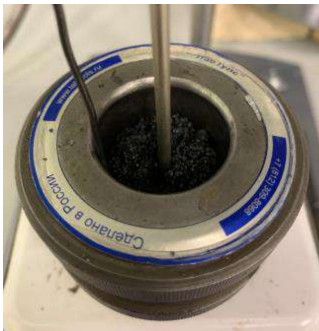
Рисунок 2.4 – Приготовление композита для формовки электрода
