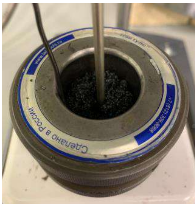
Рисунок 4.4 – Нагрев шихты до температуры смешения
