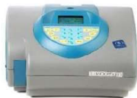
Рисунок 2.9 – Энергодисперсионный рентгенофлуоресцентный анализатор массовой доли серы СПЕКТРОСКАН S
