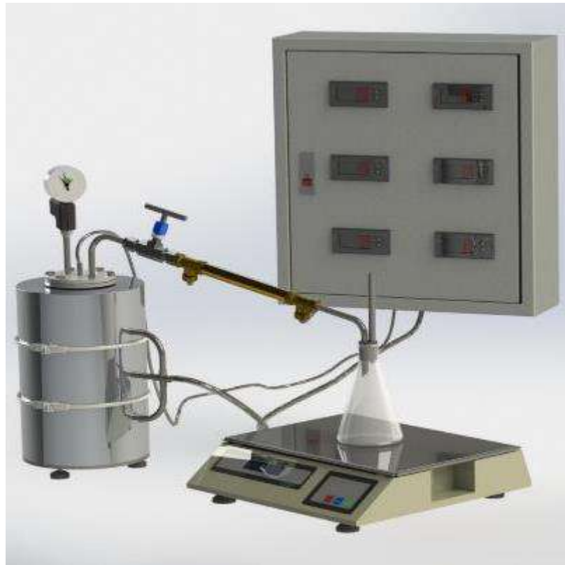
Рисунок 2.1 – 3D модель лабораторной установки замедленного коксования «УЗК-1»: 1 – реакторный блок; 2 – охлаждающий блок; 3 – блок продуктов; 4 – блок электронного управления [25]
