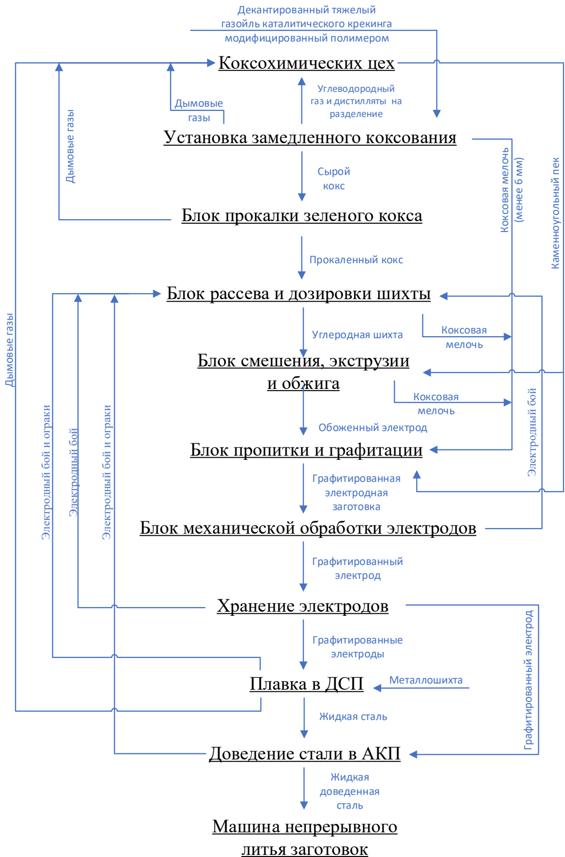
Рисунок 5.2 – Принципиальная технологическая схема полного цикла получения графитированных электродов на металлургическом предприятии
