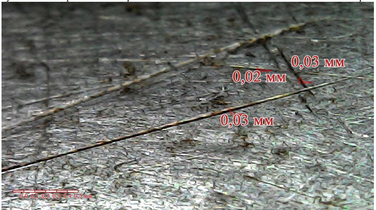
Рисунок Г6 – Микроснимок поверхности области максимального наклепа изношенной коронки
