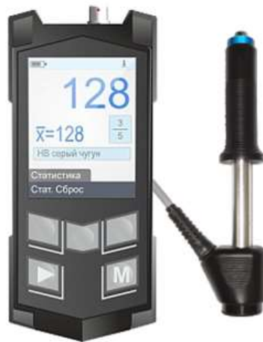
Рисунок 3.6 – Портативный твердомер Константа-КТ с преобразователем по динамическому методу Либа тип D [65]
