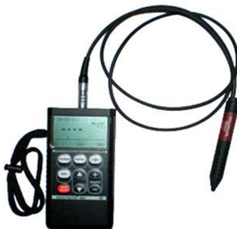
Рисунок 3.10 – Вихретоковый дефектоскоп Константа ВД-1 с преобразователем ПФ-ОН-14-Fe для ферромагнитных сталей [15]
