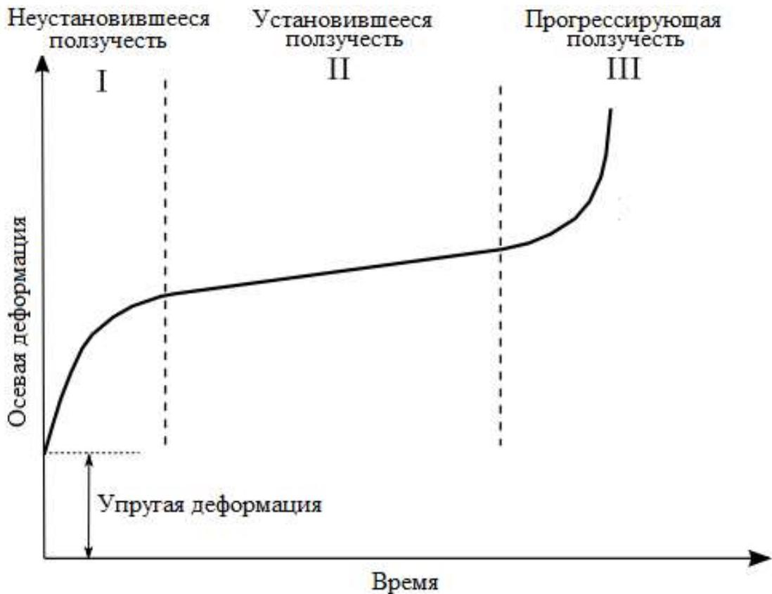
Рисунок 1.4 – типичные реакции, наблюдаемые при длительных испытаниях на ползучесть [101]
