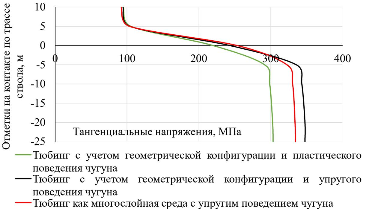
Рисунок 3.15 – Развитие тангенциальных напряжений во внешних ребрах тубинговой крепи по трассе рассматриваемого участка вблизи контакта двух сред, для различных подходов моделирования крепи.
