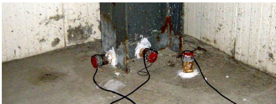
Рисунок А3 – Точка регистрации № 2 (использовались датчики СВ5)
