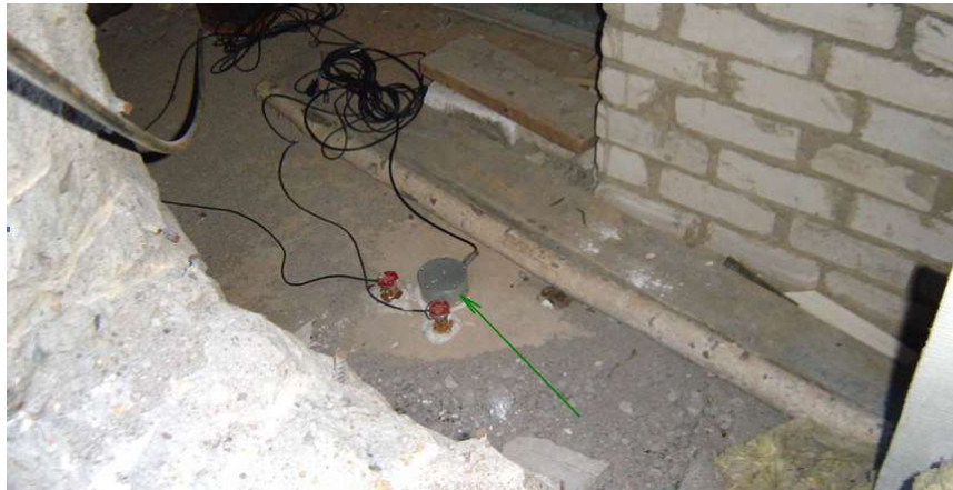
Рисунок А2 – Точка регистрации № 1. Стрелкой показан датчик сейсмической станции «Minimax», рядом установлены датчики СВ-30
