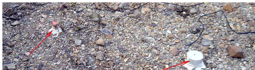
Рисунок А5 – Точка регистрации № 4. Стрелками показаны датчик СВ-30 и датчик сейсмической станции «Minimax»
