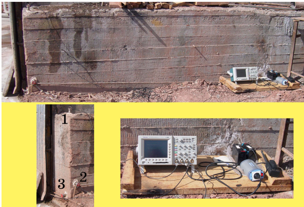
Рисунок 2.3 – Измерительный комплекс в пункте P2. Сейсмические датчики компонент скорости смещения: 1 – вертикальной; 2 – радиальной (в направлении на взрыв); 3 – тангенциальной (перпендикулярно направлению на взрыв)
