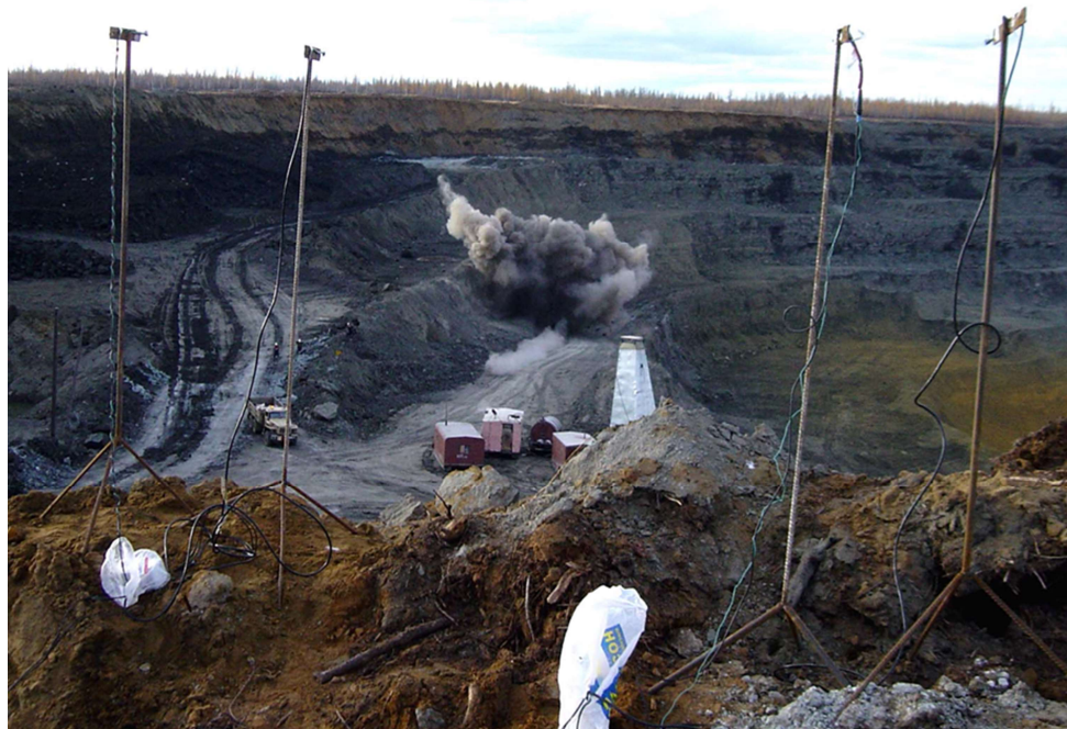
Рисунок 5.33 – Расстановка датчиков УВВ у борта карьера и вид на взрыв 3-го наружного заряда взрывчатого вещества
