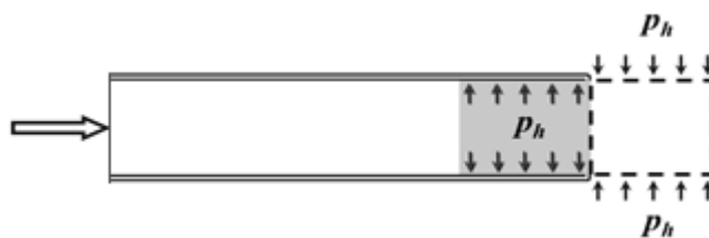
Рисунок 3.12 — Начальная стадия формирования породы в трубе
