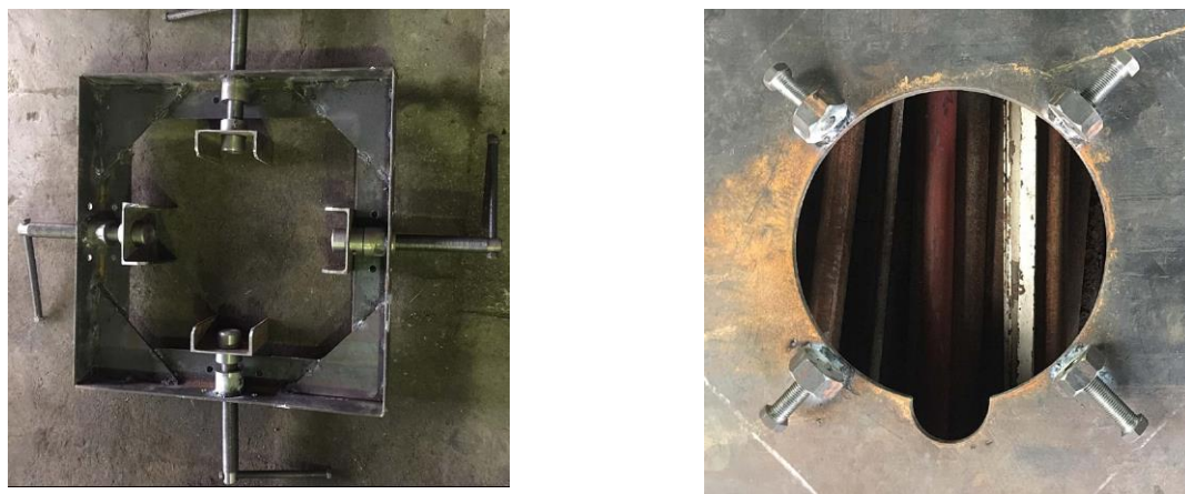
Рисунок 4.10 — Регулировочный пояс: а — верхний; б — нижний
