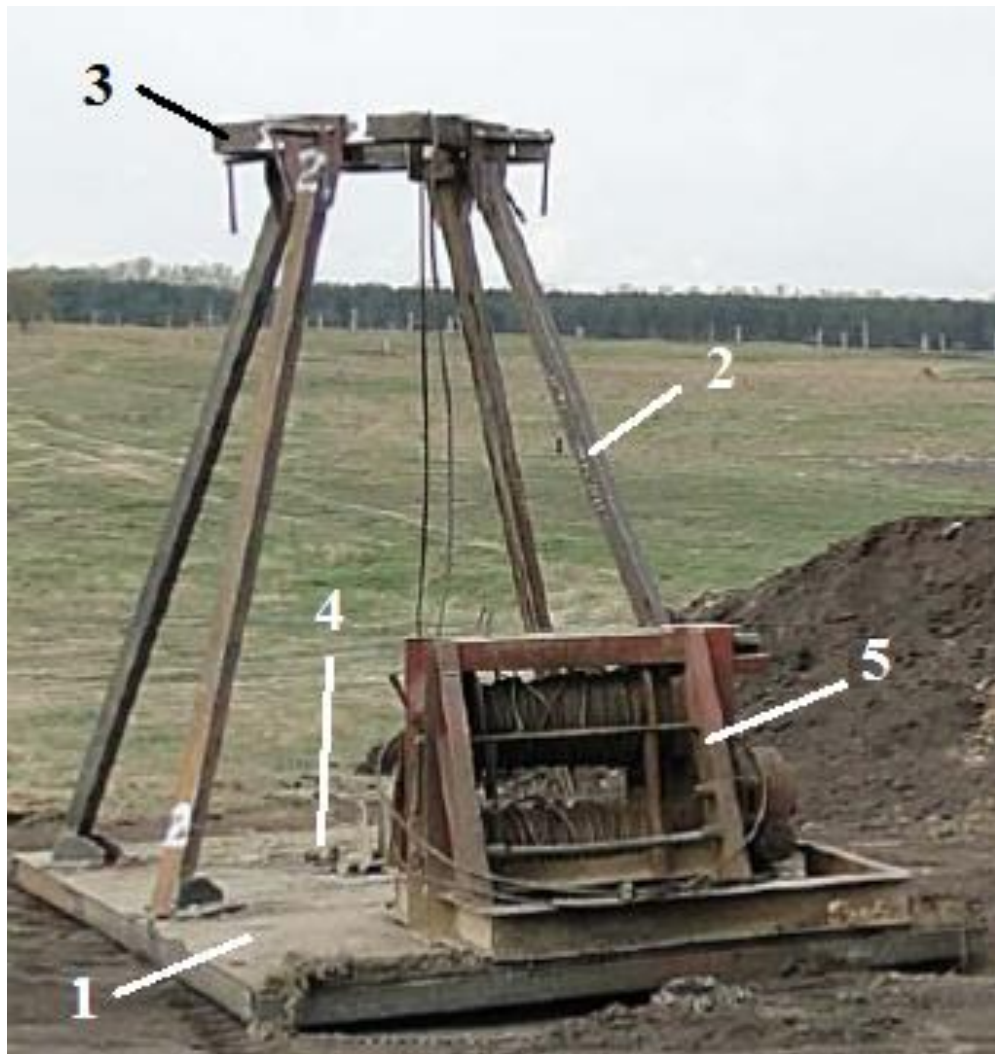
1 — основание; 2 — опоры; 3 — верхний регулировочный пояс; 4 — нижний регулировочный пояс; 5 — лебедка
