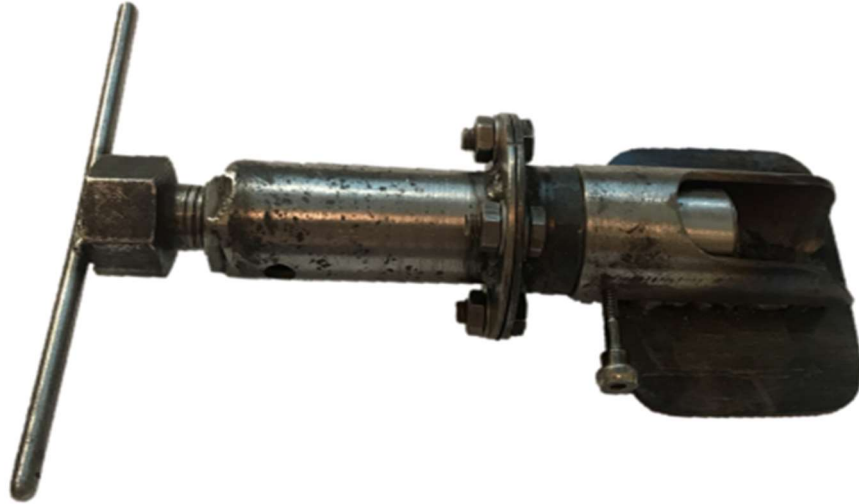
Рисунок 4.2 – Устройство для подготовки таблеток из углеродной массы
