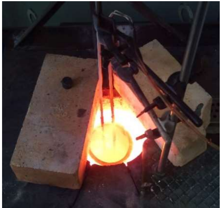
Рисунок 4.6 – Лабораторная установка для карботермического восстановления кремния: 1 – токоподвод в виде стального стержня; 2 – токоподвод; 3 – шахтная печь; 4 – образец электрода; 5 – расплав; 6 – нагревательный элемент; 7 – графитовый тигель; 8 – штанга; 9 – термопара ТХА;
