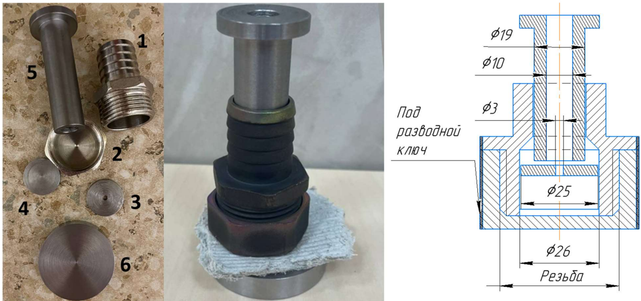
Рисунок 4.3 – Прототип лабораторного экструдера: 1 – загрузочная камера; 2 – неподвижное дно; 3 – подвижное дно (экструзионная матрица); 4 – сменное подвижное дно (пресс); 5 – полый шток (исполнительное устройство); 6 – опорная площадка.
