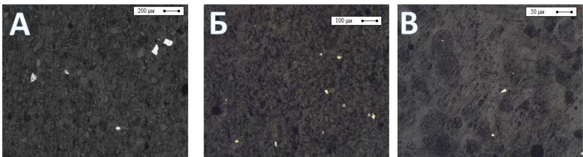
Рисунок Г.4 - Время измельчения 60 минут: а) +71 мкм, б) -71+40 мкм, в) -40 мкм
