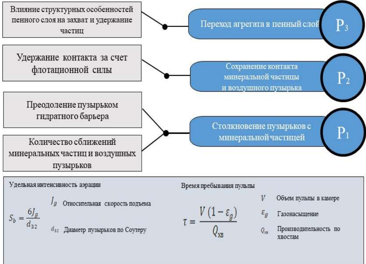
Рисунок 2.6 – Графическое отображение взаимосвязи вероятности флотационного извлечения и параметров флотиремости
