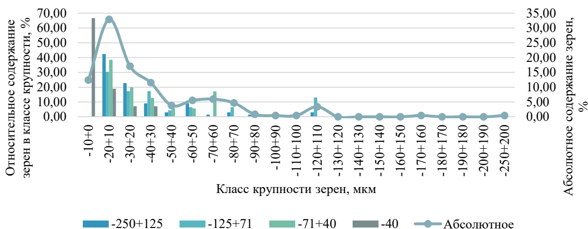
Рисунок 3.5 – Распределение по крупности зерен сульфидных минералов при крупности измельчения P_{80} = 88,89 мкм
