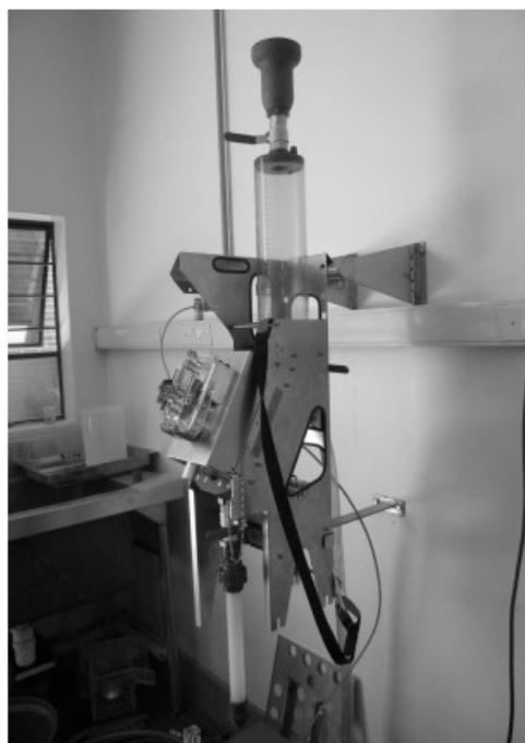
Рисунок 1.3 – Устройство «Anglo Platinum Bubble Sizer» [131]
