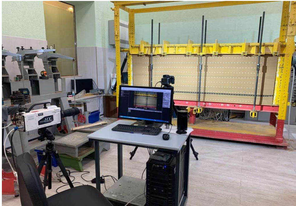
Рисунок 3.18 – Принципиальная схема модели (а) и общий вид модели из эквивалентных материалов (б) в процессе ее отработки
