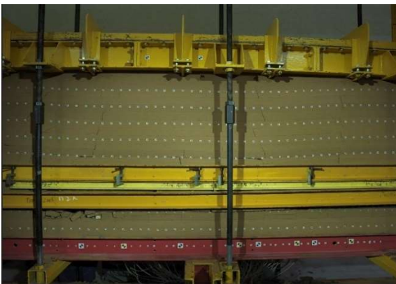
Рисунок 3.20 – Процесс деформирования пород кровли пласта при различной мощности защитной угольной пачки: а – без защитной пачки угля; б – при мощности защитной пачки 1 м; в - при мощности защитной пачки 2 м; г - при мощности защитной пачки 3 м.
