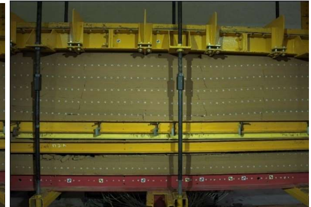
Рисунок 3.20 – Процесс деформирования пород кровли пласта при различной мощности защитной угольной пачки: а – без защитной пачки угля; б – при мощности защитной пачки 1 м; в - при мощности защитной пачки 2 м; г - при мощности защитной пачки 3 м.
