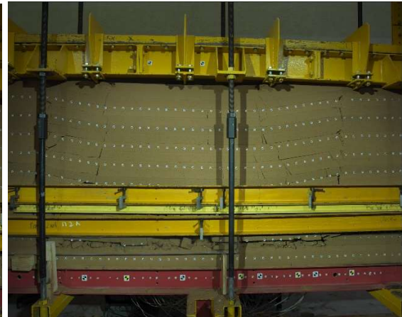
Рисунок 3.21 – Процессы деформирования и разрушения основной и непосредственной кровли и почвы лавы верхнего слоя при подвигании очистного забоя относительно базового положения на расстояние: а - 8м; б - 15м; в - 23м; г - 60м; д - 170м; е - 180м
