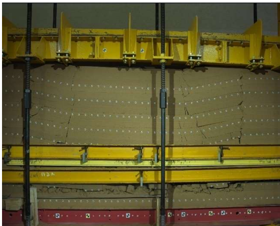
Рисунок 3.21 – Процессы деформирования и разрушения основной и непосредственной кровли и почвы лавы верхнего слоя при подвигании очистного забоя относительно базового положения на расстояние: а - 8м; б - 15м; в - 23м; г - 60м; д - 170м; е - 180м
