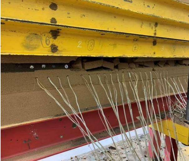
Рисунок 3.19 – Схема расположения датчиков в модели: а - для определения напряжений, б, в – подключение датчиков к компьютеру для обработки показаний
