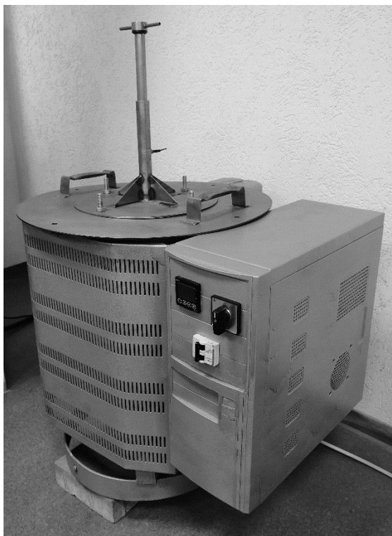
Рисунок 2.5 – Экспериментальный стенд для осуществления процесса поверхностного легирования из среды расплавов легкоплавких металлов
