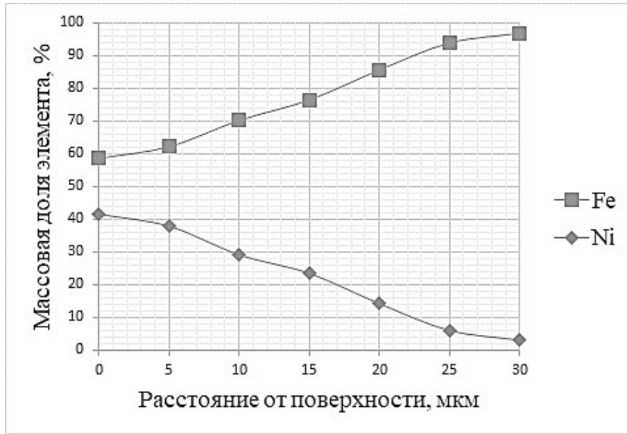
Рисунок 4.4 – Распределение концентрации Ni и Fe в области поверхностного легирования
