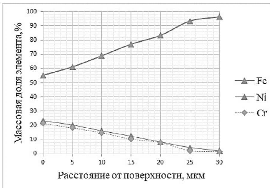
Рисунок 4.6 – Распределение концентрации Ni и Fe в области поверхностного легирования
