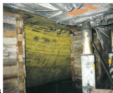
Рисунок 1.9 – Формирование демонтажной камеры с применением гибкого перекрытия из полимерной сетки: а – принципиальная схема демонтажной камеры; б – гибкое сетчатое перекрытие; в – охрана демонтажной камеры со стороны выработанного пространства [23, 66, 84]
