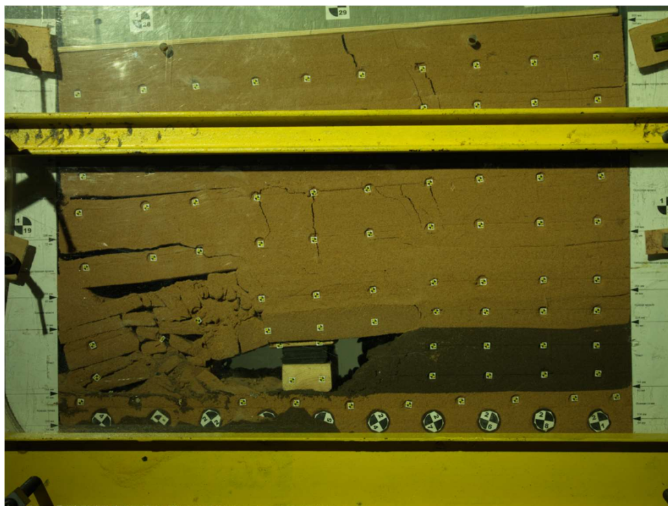
Рисунок 2.25 – Разрушение краевой части пласта при суммарной подвижке крепи 3,2 м (6,4 см) в течение непродолжительного времени
