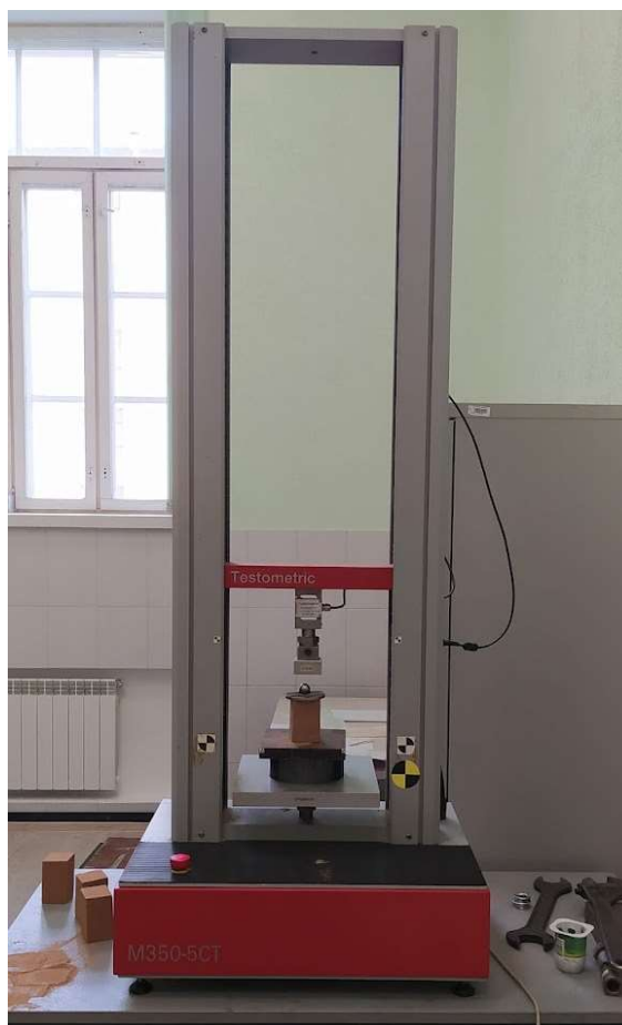
Рисунок 2.2 – Подготовка образца к испытанию на приборе Testometric
