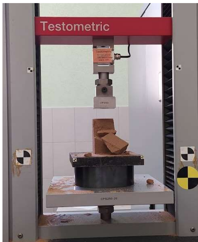
Рисунок 2.5 – Разрушение образца в процессе испытания на одноосное сжатие
