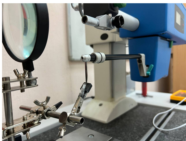
Рисунок 3.5 – Измерение скругления режущей кромки на профилограф- профилометре Hommel Tester T8000
