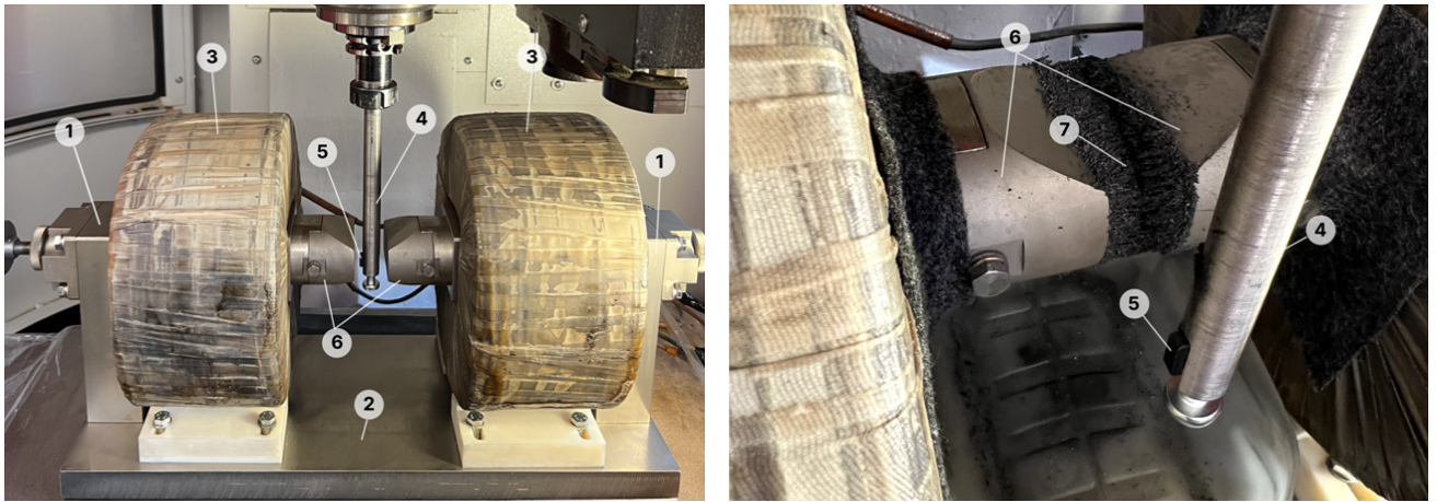
Рисунок 2.6 – Устройство на базе фрезерного станка для магнитно-абразивной обработки, где 1 – Г-образные элементы, 2 – основание с опорами, 3 – электромагнитные катушки, 4 – вспомогательное приспособление крепления керамических пластин, 5 – керамическая пластина, 6 – сменные полюсные наконечники, 7 – магнитно-абразивный порошок
