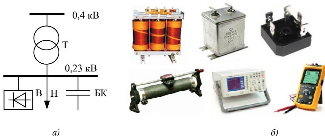
Рисунок 2.16 - Физическая модель системы электроснабжения: а) – схема лабораторной установки, б) элементы и приборы измерения, входящие в схему
