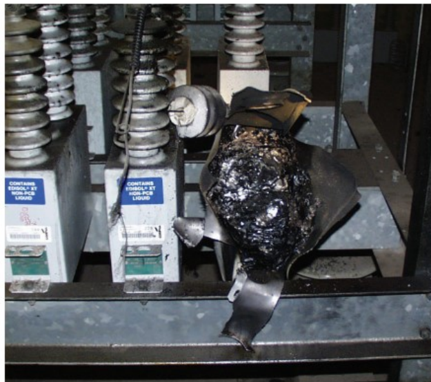
Рисунок 2.2 - Выход из строя конденсатора на предприятии при резонансном режиме сети
