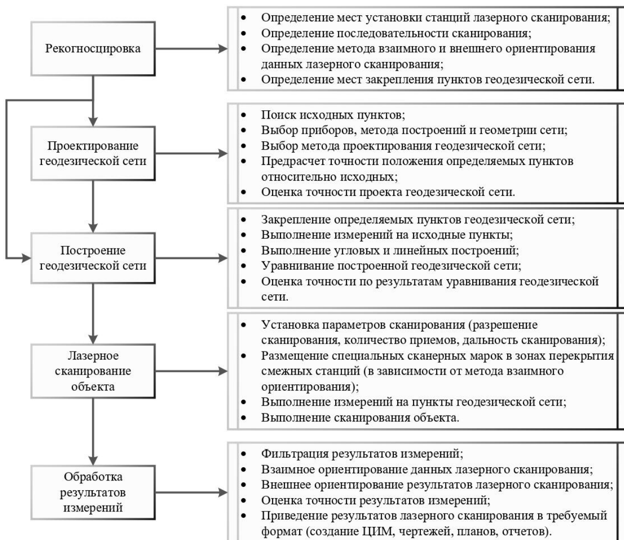
Рисунок 1.6 – Обобщенная технологическая схема наземного лазерного сканирования
